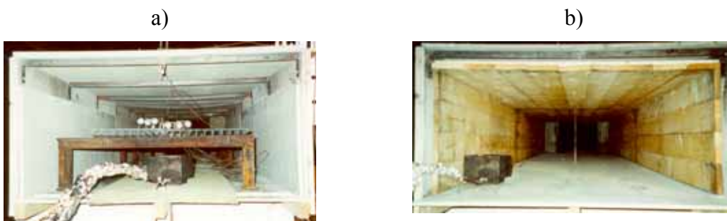
Kuva 3. a) Palokuorman asentaminen ja sytyttämiseen käytetyn polttimen paikka kaapelipalokokeissa. b) Puuontelokokeissa palokuorma oli seinien verhoiluna ja poltin sijaitsi seinän vieressä.
