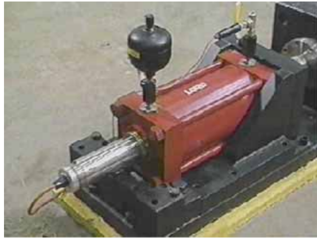
Kuva 30. Kerrostalon värähtelyjen vaimentaminen MR-vaimentimien avulla [88].
