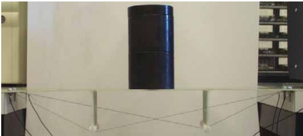
Kuva 66. Kuormitusten aiheuttaman taipuman aktiivinen oikaiseminen muistimetallilankojen avulla. VTT Tuotteet ja tuotanto, patenttihakemus FI 20045053.
