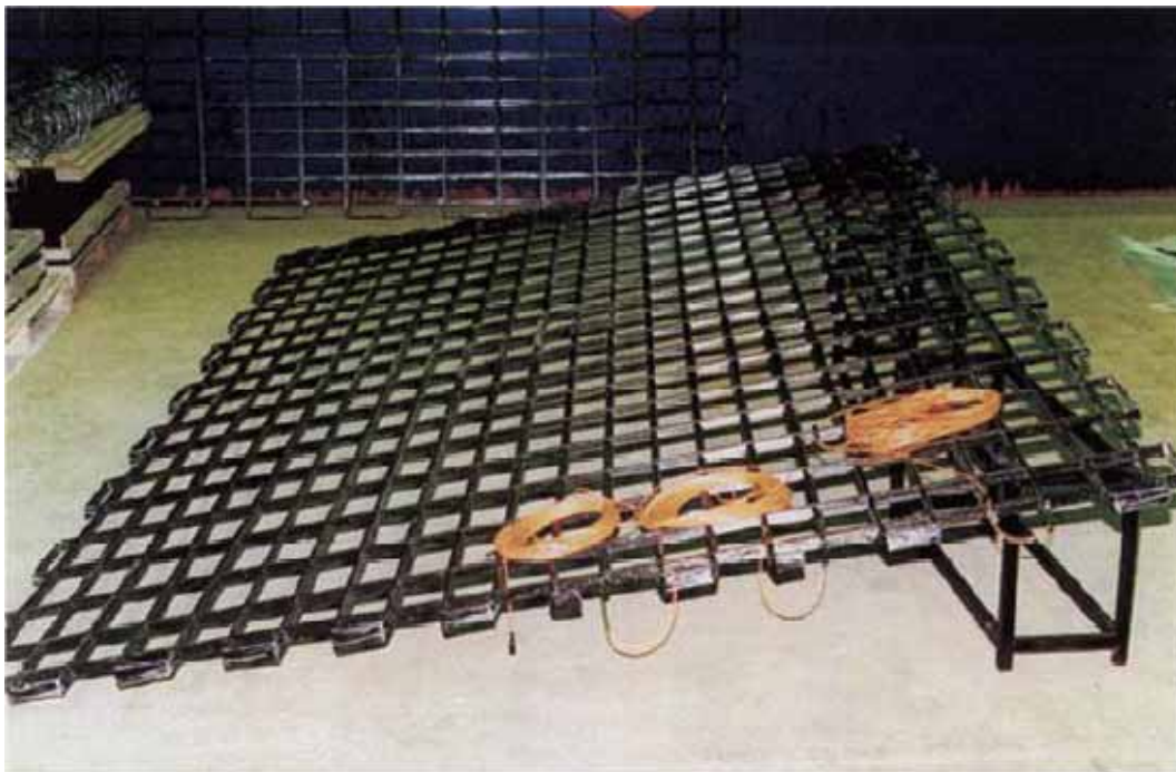
Kuva 56. Kuituoptisia sensoreita sillan kannen lujitemuovisessa tukirakenteessa [217].
