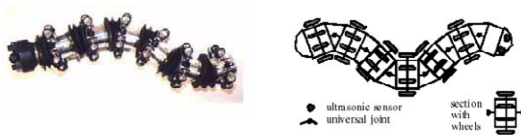
Kuva 24. Robottikäärme sortuneiden rakennusten tutkimiseen [52].
