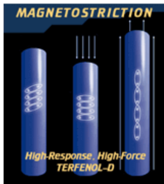
Kuva 7. Magnetrostriktiivisen materiaalin käyttäytyminen [6].
