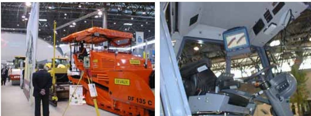
Kuva 6. 3D-paikkannusjärjestelmällä varustettu asfaltinlevitin ja GPS-paikkannukseen perustuva täryjyrän ohjausjärjestelmä Intermat-messuilla Pariisissa 2003 (kuvat VTT).
