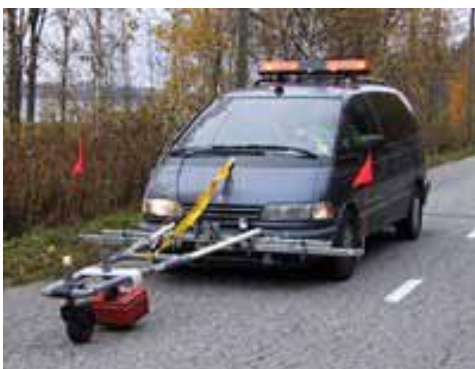
Kuva 3. Tien pohjan kuntokartoitus maatukamittauksella ja rakenteen parantamissuunnitelman tekeminen RoadDoctor-ohjelmalla (kuvat Roadscanners Oy).
