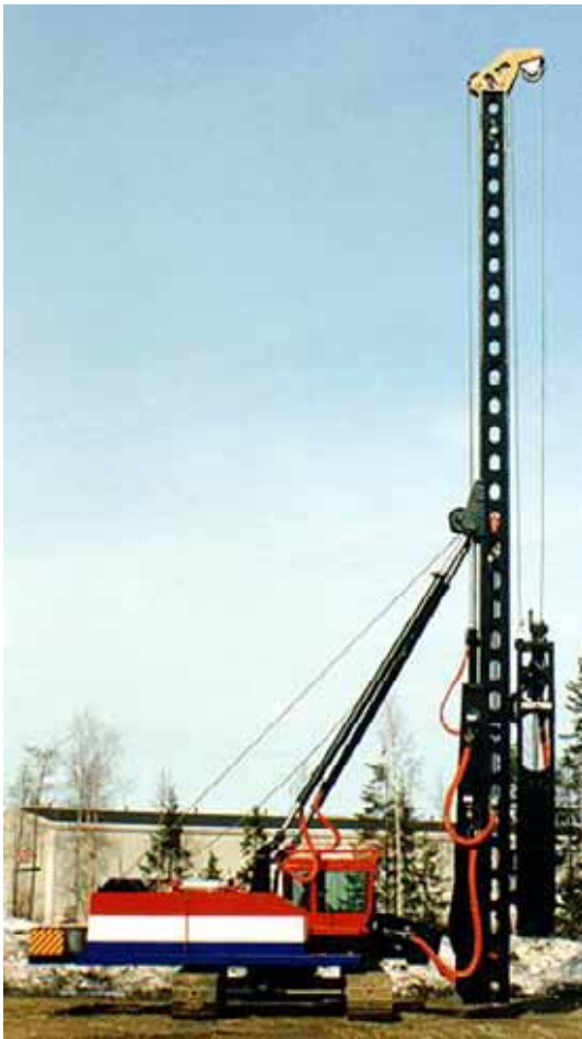
Kuva 5. Pohjanvahvistus lyöntipaalutuksella ja syvästabiloinnilla (kuvat Junttan Oy ja YIT Oy).
