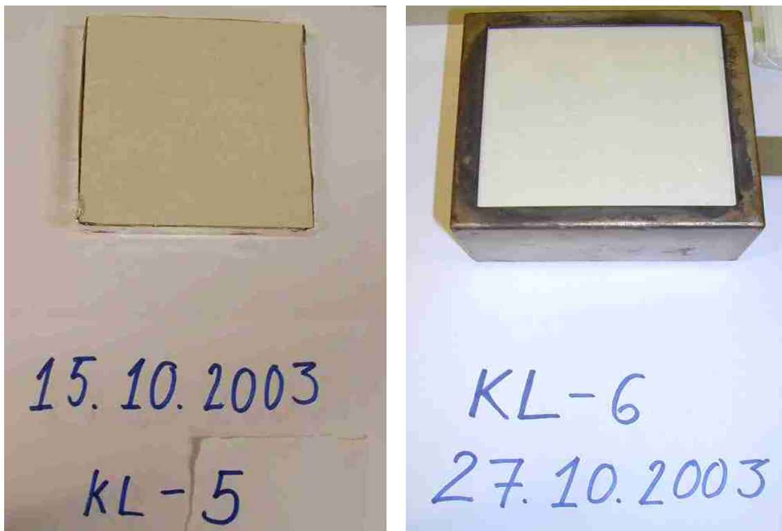
Kuva B1. Kipsilevynäytteitä valokuvattuina ennen koetta. Vasemmalla näyte ennen näytteenpitimeen asettamista. Näytteen reunojen ympärillä näkyy alumiinifoliota, jolla näytteenpidintä suojataan palamisjätteiltä. Oikealla näyte näytteenpitimeen asettamisen jälkeen.
