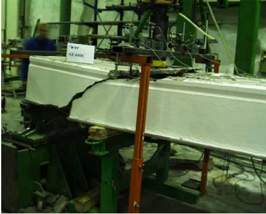
Fig. 31. SF400C. Failure mode.
