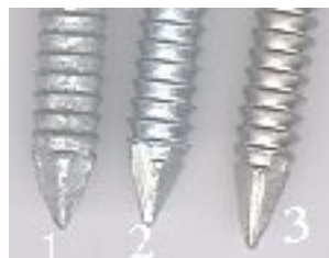
Kuva 2.12. Ankkurinaulojen kärkiä, d = 4\text{ mm} .
