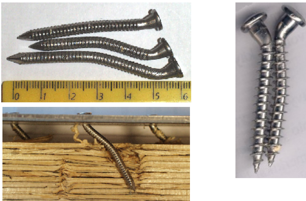
Kuva 3.33. Vetoliitoksokokeessa olleita nauvoja AA5 (kaksi ylintä) ja AA3 sekä ankkuri-ruuvit AR (oik.). Alhaalla vasemmalla liitoksen KVT1-4-3 murtotapa, naula AA5.
