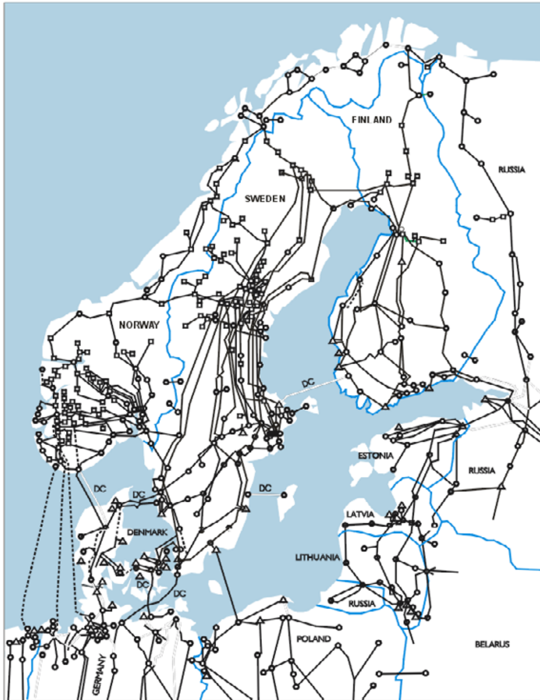
Kuva 5. Pohjoismaiden sähkösiirtojärjestelmä ja yhteydet muualle Eurooppaan.
