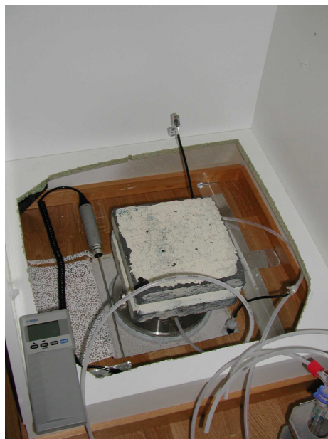
Kuvat 10 ja 11. Kaapiston alapuoliseen sokkelitilaan lattiarakenteen seurantamittauksia varten rakennettu, avattavissa oleva lattiapinnoite.
