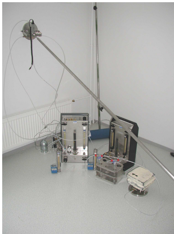
Kuva 2. Emissionäytteenotto seinä- ja lattiarakenteesta FLEC-tekniikkaa hyödyntäen.
