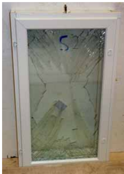
Kuva 25. Eristyslasin tyypillinen rikkoutumiskuvio kokeessa.
