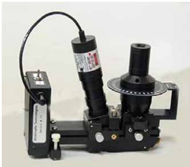
Kuva 23. Lasin pintajännityksen mittari (Strainoptic).
