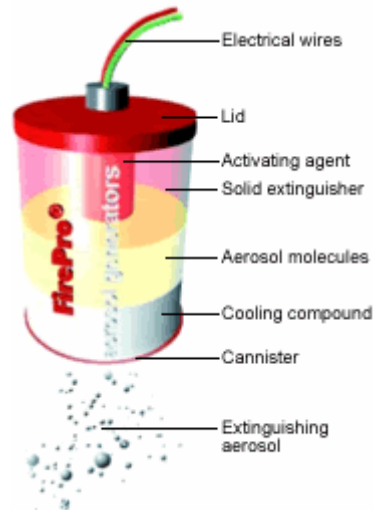
Kuva 4.20. Aerosolipatruunan läpyleikkaus. Lähde: www.firepro.nl .
