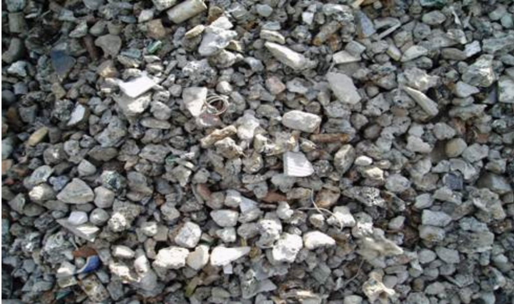
Kuva 12. Prosessoitua pohjatuhkaa, josta hienoaines on poistettu. Materiaali vastaa rakeisuudeltaan likimain murskettä.
