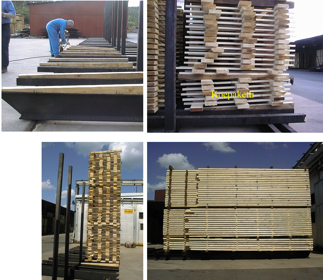
Kuva 35. Koekuivauksissa käytetyt viistetyt aluspuut ja rimakuorma. Korkeakin kuorma pysyy hyvin pystyssä.
