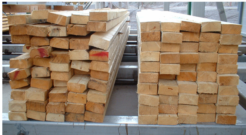
Kuva 24. Kuormitettuja ja kuormittamattomia sahatavaroita kuivauksen jälkeen.
