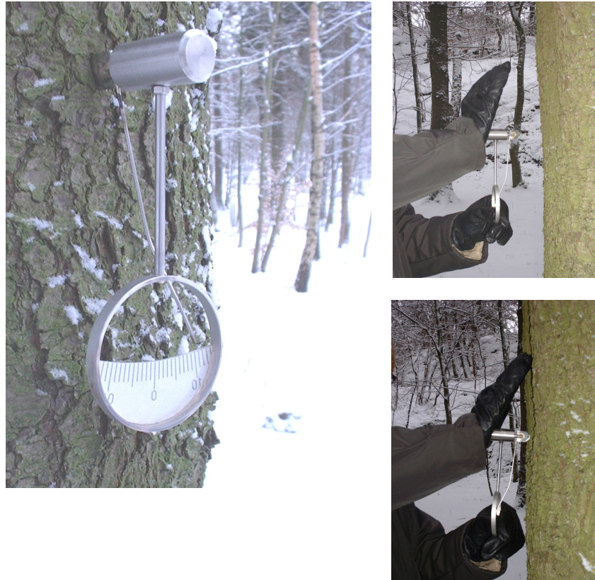
Kuva 6. Puun kierresyisyyden määrittäminen S-GAG-mittalaitteella.
