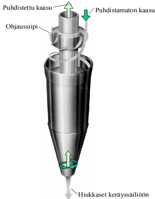
Kuva 3.1. Aksiaalisella sisäänvirtauksella toimiva vastavirtasykloni.
