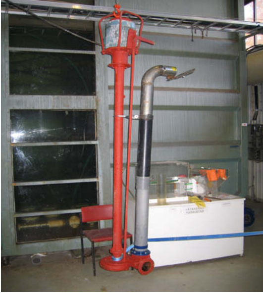
Kuva 7. Lietepumppu varustettuna hajotinlevyllä (vasen kuva) ja 4" poistoletkulla, taustalla Suomenojan koeallas.
