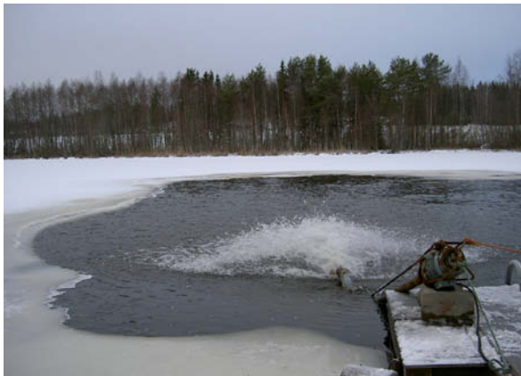
Kuva 58. Lietepumppu varustettuna hajotinlevyllä toiminnassa Ruutinlammella talvella 2004 (kuvat: Aarre Arrajoki).
