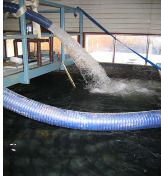
Kuva 7. Lietepumppu varustettuna hajotinlevyllä (vasen kuva) ja 4" poistoletkulla, taustalla Suomenojan koeallas.
