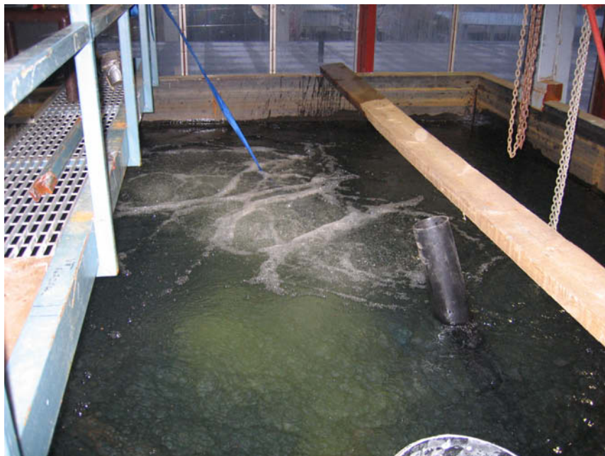
Kuva 10. Ilma ja vesi sekoittuvat ejektorissa, ja seos johdettiin 1,4 m:n syvyyteen.
