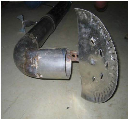
Kuva 8. Hajotinlevy (vasen kuva) ja levyn vaikutus kokeissa.
