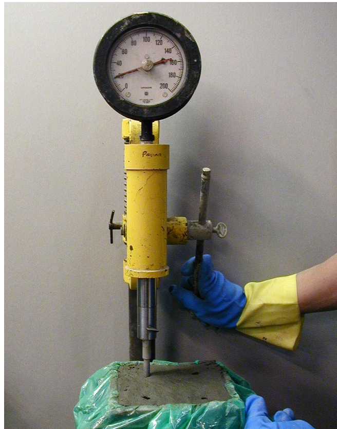
Kuva 9. Tunkeutumisvastuksen ja tärytysrajan määrittäminen.
