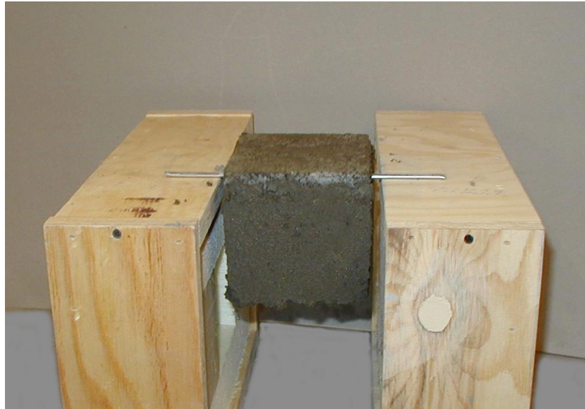
Kuva 11. Betonikappale on ripustettu 3 minuutin kuluttua kiihdytinlisäyksestä.
