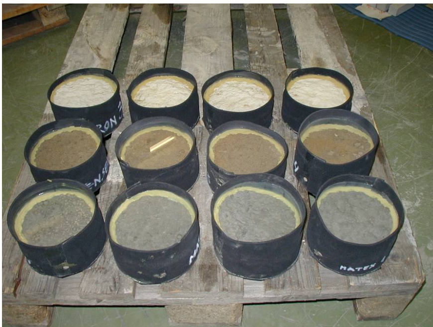
Kuva 14. Ruiskutetuista laatoista irrotetut näytepalat ennen pakkasenkestävyyden määrittämistä. Lähinnä alareunaa koalueen 1 betoni (pinnoittamaton). Keskellä Motex Dry Coat ja ylinnä Penetron®.
