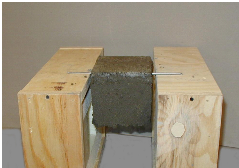
Kuva 11. Betonikappale on ripustettu 3 minuutin kuluttua kiihdytinlisäyksestä.
