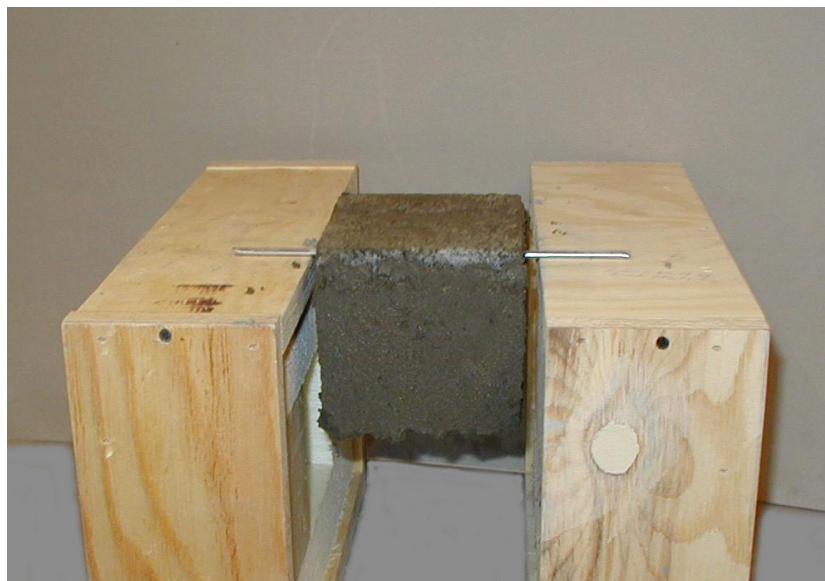
Kuva 11. Betonikappale on ripustettu 3 minuutin kuluttua kiihdytinlisäyksestä.
