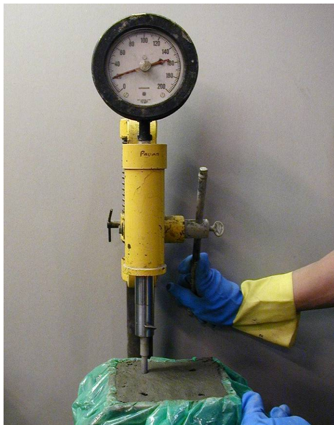
Kuva 9. Tunkeutumisvastuksen ja tärytysrajan määrittäminen.
