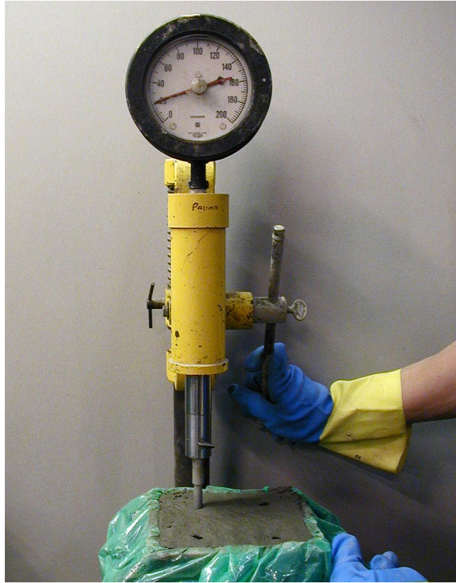
Kuva 9. Tunkeutumisvastuksen ja tärytysrajan määrittäminen.
