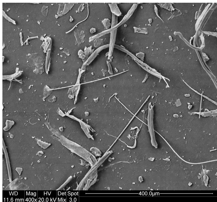
Kuva 26. SEM-kuva huonepölystä kohteessa 4. Kuvassa näkyy tekstiili- ja paperikuituja sekä kiviaineshiukkasia. Pyöreät sileäpintaiset kuidut ovat teollisia mineraalikuituja.
