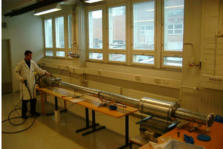
Kuva 4. Puhdistettavuus- eli harjaustestissä pyörivä harja työnnetään kanavaan.
