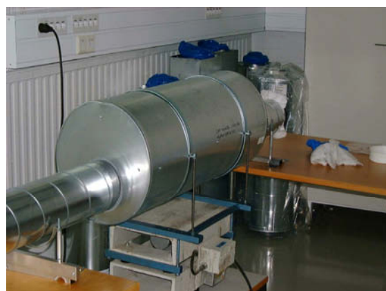
Kuva 3. Testattavia äänenvaimentimia värinäalustalla erilaisilla kiinnityksillä.
