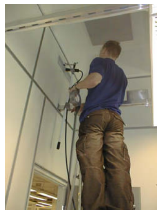
Kuva 34. Hiukkaspitoisuuden mittaaminen tuloilmaelimen kohdalta.
