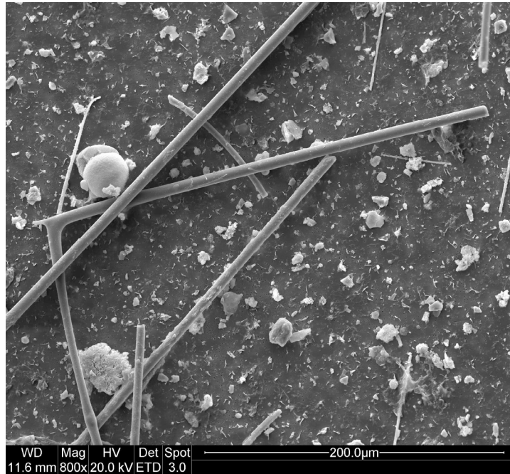
Kuva 28. SEM-kuva tuloilmakanavan pölystä kohteessa 7. Pöly koostuu pääasiassa karkeista teollisista mineraalikuuduista ja karkeasta ulkoilman pölystä (siitepöly, kiviaines).
