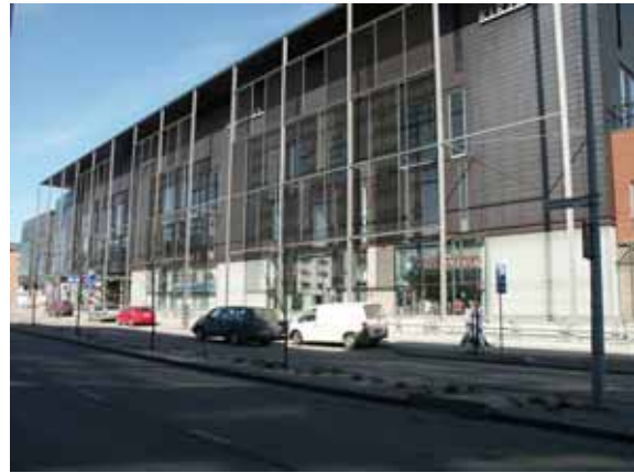
Kuva 7.1a ja b. Auringon säteilyn aiheuttaman yllilämpenemisen torjuminen ulkopuolisten säleiden avulla.
