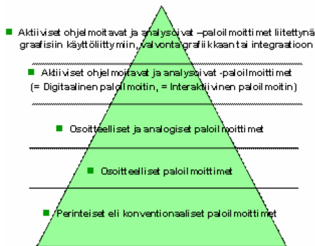
Kuva 3. Paloilmotimet ryhmiteltyinä palonilmaisuoiminaisuuksien perusteella.
