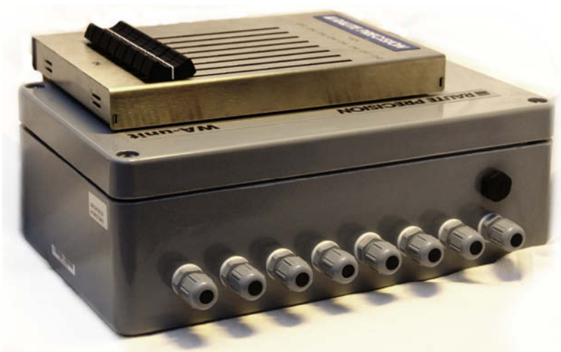
Kuva 4. Lahti Precisionin WA-8-mittausyksikkö (alla) ja mittausyksikköön kytketty liukupotentiometri toimiva anturikuormitussimulaattori (yllä).
