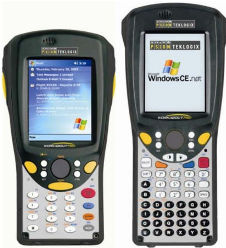
Kuva 5. Esimerkki modernista käsipäätteestä: Psion WorkAbout Pro 13 -pääte-laite, jolla on mahdollista lukea sekä RFID-tageja, että viivakoodeja.
