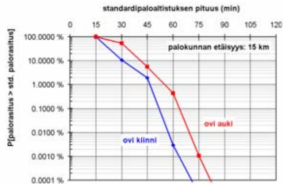
Kuva 182. Katokseen kohdistuvan lämpösäteilyn kertynyt arvo standardipalorasituksena tulkittuna, yhteenveto käyttäen kahta eri palavien autojen osuuden skenaarioita: a) yksi auto 90 %, kolme autoa 9 % ja viisi autoa 1 % sekä b) yksi auto 90 %, kolme autoa 9,9 % ja viisi autoa 0,1 %.
