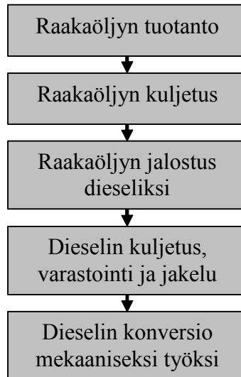
Kuva 5. Fossiilisen dieselin elinkaaren kasvihuonevaikutustarkastelun rajaus. Raakaöljyn tuotannon ja kuljetuksen jälkeen raakaöljy jalostetaan dieseliksi. Diesel kuljetetaan, varastoidaan ja jaellaan kuluttajille. Viimeisenä elinkaaren vaiheena huomioidaan dieselin konversio hyötyenergiaksi.
