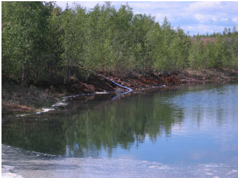
Kuva 10. Sianlanta lisätään vedellä täyttyneeseen avolouhokseen pumppaamalla.
