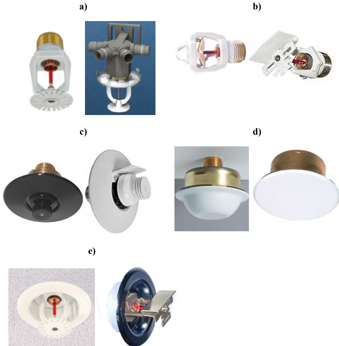
Kuva 4. Erityyppisiä asuntosprinklerisuuttimia: a) alaspäin asennettava, b) sivusprinkleri, c) Flush-sprinkleri, d) piilosprinkleri ja e) upotettava sprinkleri. Kuvat otettu seuraavista internetlähteistä: www.vikinggroupinc.com , www.uponor.fi , www.tyco-fire.com ja www.reliablesprinkler.com .
