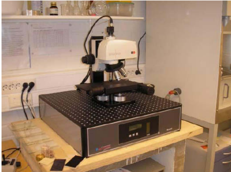
Kuva 8. Optinen profilometri Sensofar Pl \mu 2300.
