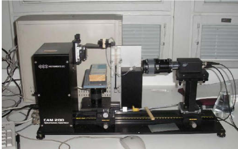
Kuva 3. KSV Instruments CAM200 -kontaktikulmamittalaitteisto.
