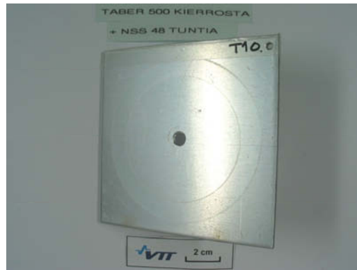
Kuvat 47 ja 48. Al99,5, ALU101, tiivistämätön ja Al99,5, ALU301, tiivistämätön.
