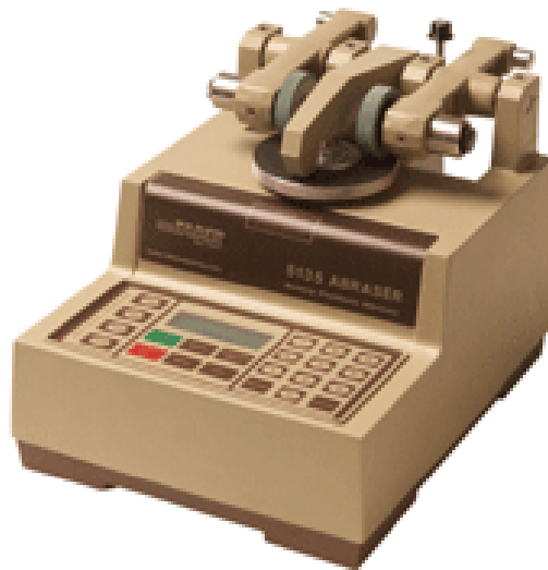
Kuva 7. Sooli-geelipinnoitteiden kulutuskestävyyttä tutkittiin Taber-kulutuskoelaitteella [23].
