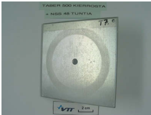
Kuvat 47 ja 48. Al99,5, ALU101, tiivistämätön ja Al99,5, ALU301, tiivistämätön.
