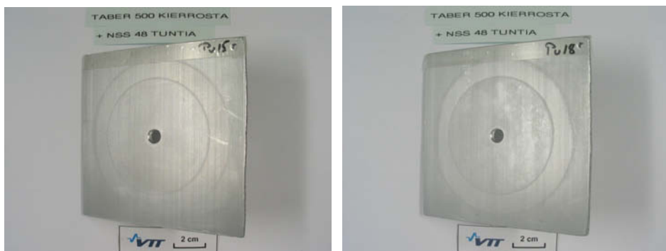
Kuvat 55 ja 56. 6060, ALU101, tiivistämätön ja 6060, ALU101, tiivistetty.
