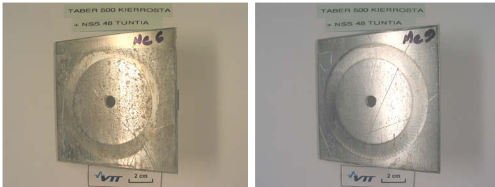
Kuvat 53 ja 54. AlMg 3 , ALU101, ei anodisointia ja AlMg 3 , ALU301, ei anodisointia.
