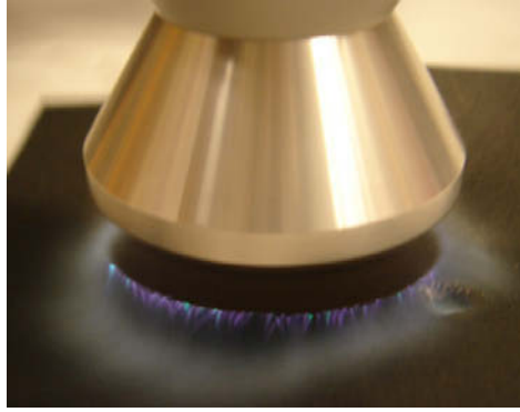
Kuva 2. VTT:n atmosfääriplasmalaitteen suutin ja plasmaliekki.
