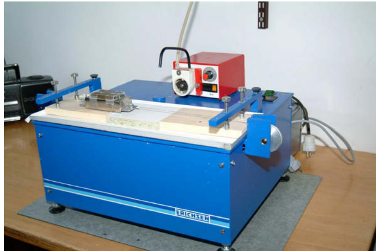
Kuva 5. Pinnoitteiden kulutuskestävyyttä tutkittiin Erichsenin maalipesulaitteella.
