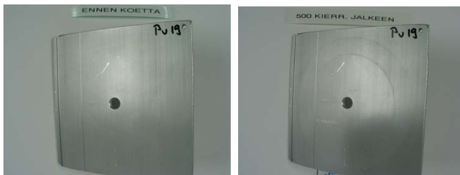
Kuvat 36 ja 37. Anodisoitu, tiivistämätön + ALU301-pinnoitettu Al6063-koelevy ennen koetta ja 500 kierroksen kulutuskokeen jälkeen.
