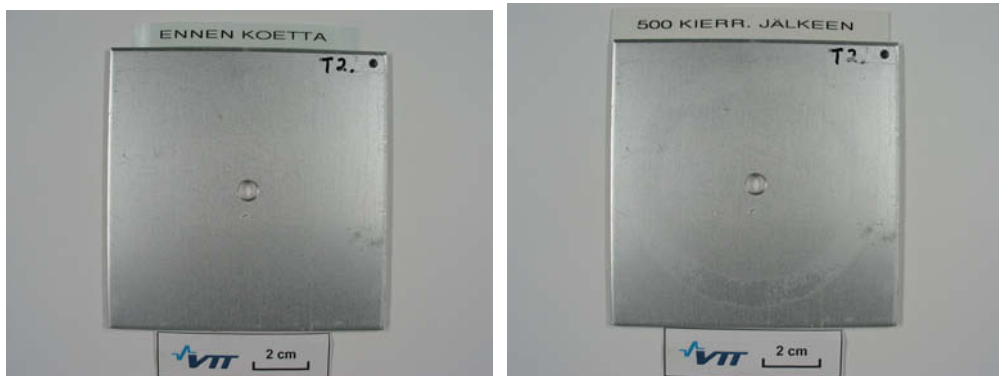
Kuvat 32 ja 33. Anodisoitu ja tiivistetty + ALU101-pinnoitettu Al99,5-koelevy ennen koetta ja 500 kierroksen kulutuskokeen jälkeen.
