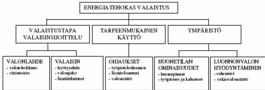
Kuva 6.17. Energiatehokas valaistus (Kallasjoki 2006, Lehtonen et al. 2007 mukaan).
