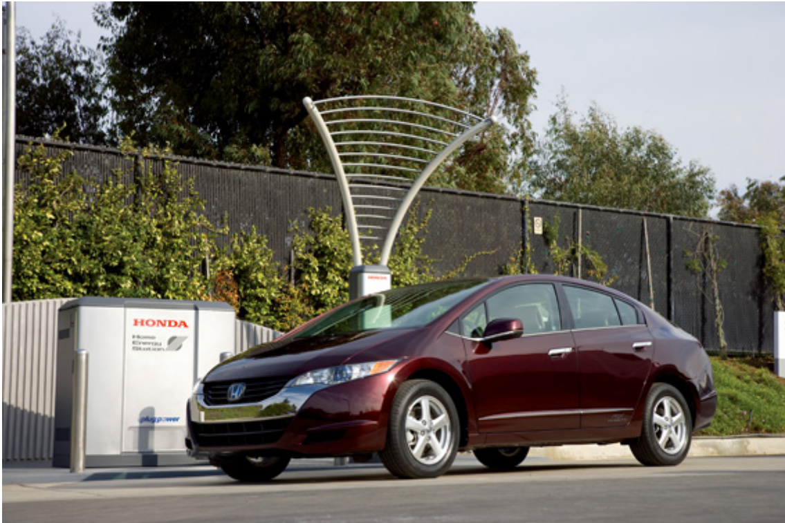
Kuva 5.4. Honda FCX Clarity ja "Home Energy Station"-vedyntuotantoyksikkö. (Honda 2007)
