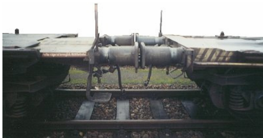
Kuva 8. Joustoelementeillä (puskimilla) varustetut vaunut [12].
