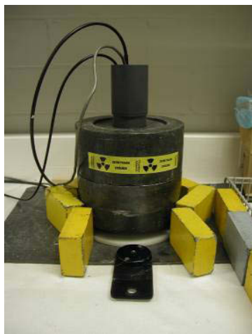
Kuva 2. Puhdistuvuustutkimuksissa ^{51}\text{Cr} :llä leimattujen likojen puhdistuvuuden määrittämiseen käytetty \text{NaI(Tl)} -kide (HY, Määttä et al. 2007b).
