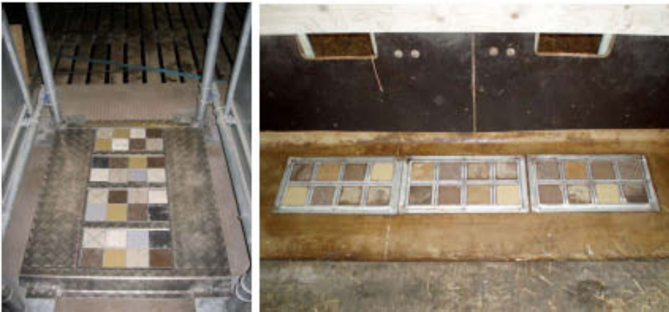
Kuva 19. Lattialle älyportin kohdalle ja ruokintapöydälle asennetut koemateriaalikehikot.
