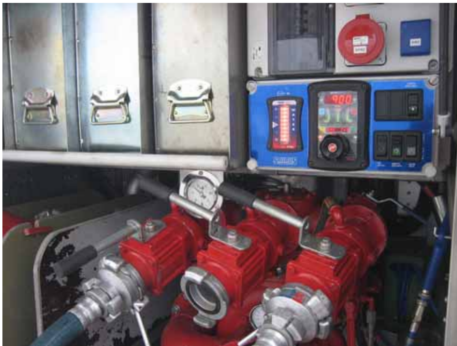
Kuva 22. Sammuttamisessa käytetty pumppu ja paineensäätöautomaatiikka.
