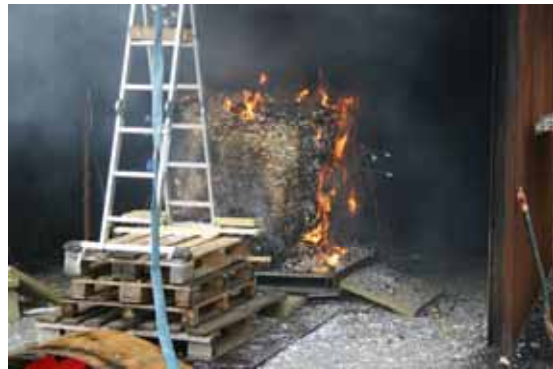
Kuva 27. Kokeen 2 (energiajapaali) valokuvia eri ajanhetkinä sytytyksen jälkeen.
