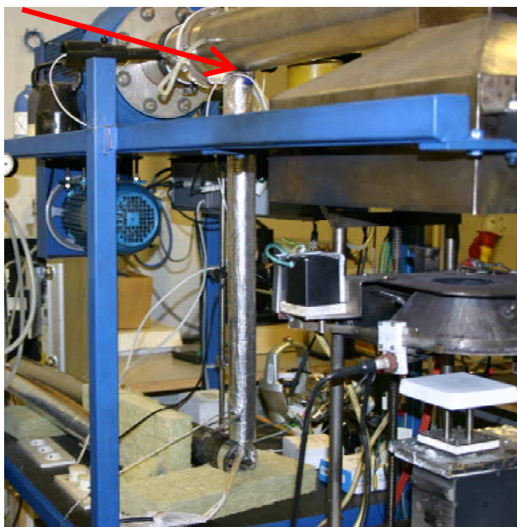
Kuva 10. Päästönäytteenotto tehtiin savukaasujen poistoputken mittausyhteestä (merkitty nuolella).
