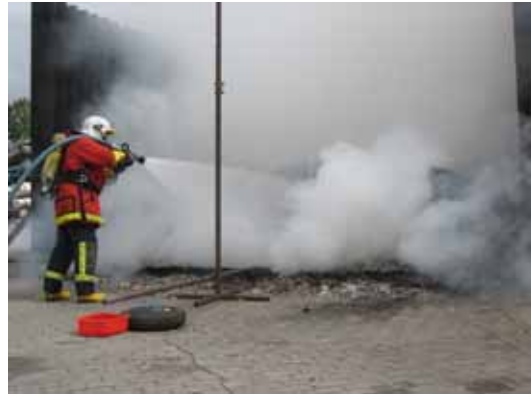
Kuva 48. Liekit kokeessa 3 energiajakeasan penkasta sammuivat 10 sekunnissa.
