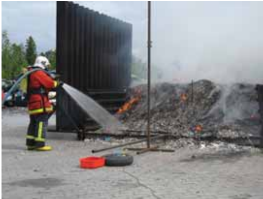
Kuva 48. Liekit kokeessa 3 energiajakeasan penkasta sammuivat 10 sekunnissa.
