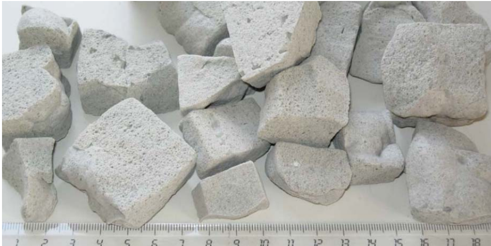
Kuva 6. Jatkuvatoimisella tasouunilla valmistettua vaahtolasimursketta (10–60 mm, ® HASOPOR).
