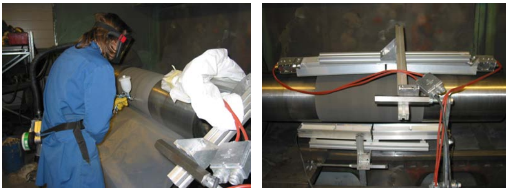
Kuva 71. Pinnoitteen ruiskutus ja kovetus IR-avusteisesti.
