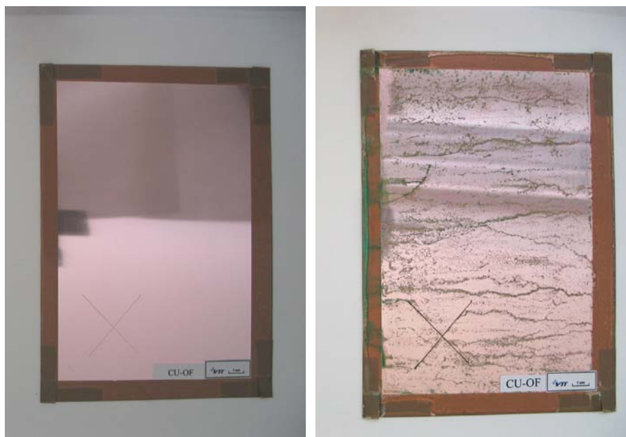
Kuvat 35 ja 36. ALD-pinnoitettu DHP-kuparilevy ennen suolasumukoetta ja 1000 h:n suolasumukokeen jälkeen.
