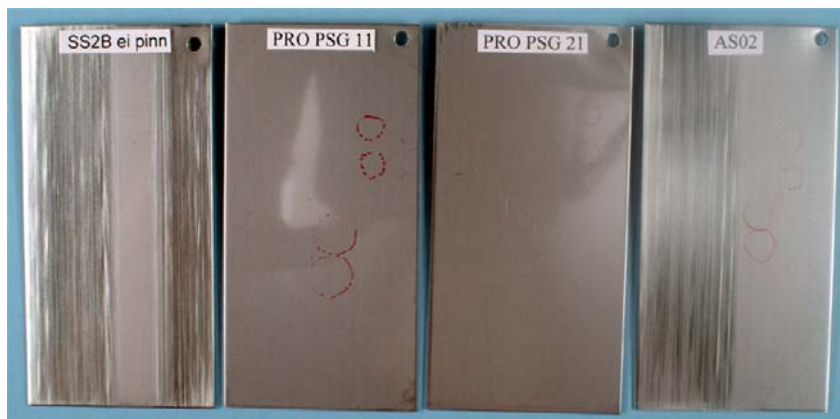
Kuva 13. Sooli-geelipinnoitetut AISI 304-teräskappaleet (2B pinnat) kulutuskokeen jälkeen (700 edestakaista hankausta karhunkielellä, 7 \text{ g/cm}^2 :n painolla). Näytteiden vasen puoli on kulutettu (pinnoittamattomasta myös oikea reuna), oikea puoli kuluttamatta.
