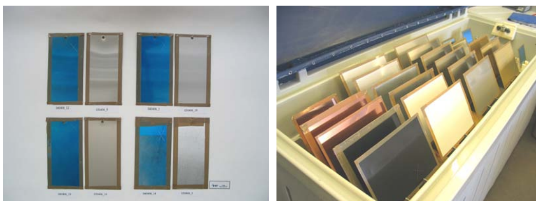
Kuvat 37 ja 38. Näytteet ennen suolasumukoetta (vasemmalla) ja 236 h suolasumukokeen jälkeen (oikealla). Perusmateriaalit vasemmalta ylhäältä alkaen: 4N, 2B, DB ja Galfan.
