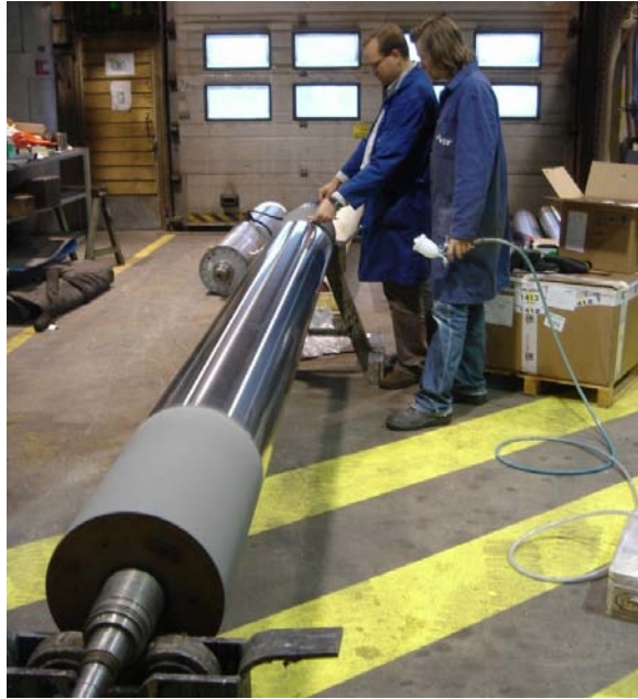
Kuva 70. Osittain termisesti ruiskutetun telan sooli-geelipinnoitus.
