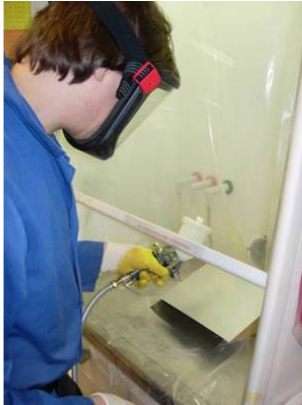
Kuva 6. Sooli-geelipinnoitteen ruiskupinnoitusta Galfan-levylle.
