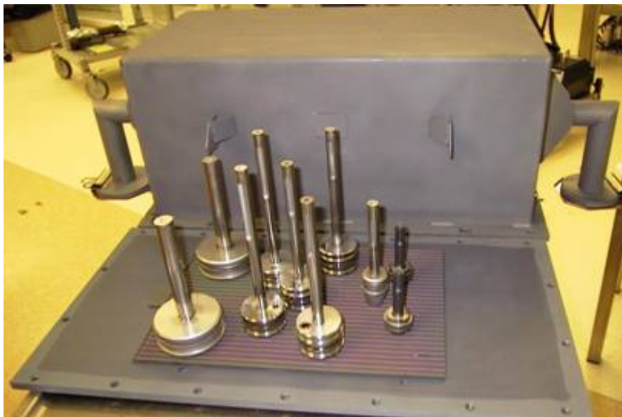
Kuva 8. ALD-käsiteltyjä 3d-muotokappaleita. Copyright Planar Systems, Inc.
