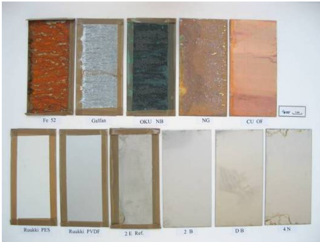
Kuva 34. Pinnoittamattomat referenssinäytteet 2 h:n suolasumukokeen jälkeen.
