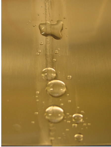
Kuva 67. Vedenhylkivyyys PSG21:llä puoliksi korjauspinnoitetulla hitsausaumalla.
