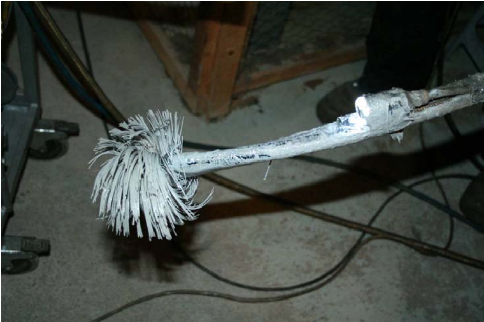
Kuva 34. Pinnoituksessa käytettävä harja, johon on integroitu kamera.
