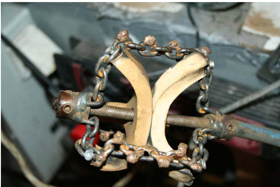
Kuva 33. Puhdistuksessa käytettävä terä.
