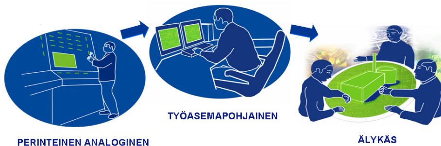
Kuva 7. Prosessiteollisuuden valvomoiden kehitys perinteisestä analogisesta digitaaliseen työasemapohjaiseen ja edelleen älykkääseen valvomoon, jossa pyritään yhdistämään analogisen ja työasemapohjaisen valvomon hyvät puolet.
