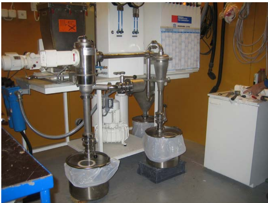
Kuva 1. Tutkimuksessa käytetty VTT:n ATP-ilmaluokittelulaitteisto.
