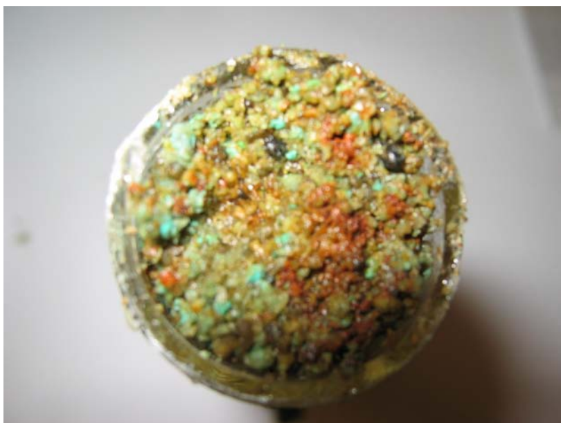
Kuva 7. Valokuva masuunihiekkakolonnin poikkileikkauksesta läpivirtauskokeen jälkeen.
