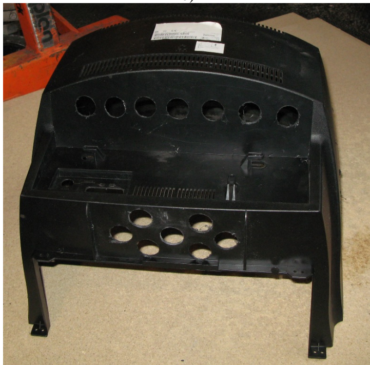
Kuva 12. a) Sytytykseen käytetty televisio ja sen alle asetettu Sinol-purkki. b) Television muovikuoreen poratut reiät.
