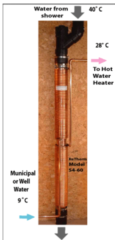
Kuva 9. Esimerkki kaupallisesta suihkuveden lämmöntalteenottolaitteesta (ReTherm, Kanada). Valmistaja esittää laitteelle jopa 60 %:n hyötysuhdearvoja. Hintaluokka 500 €.
