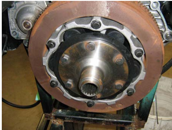
Kuva 3. Moottorin vetoakselin ja perävetolaitteen yläpäähän välinen vääntövärähtelyjen vaimennin.
