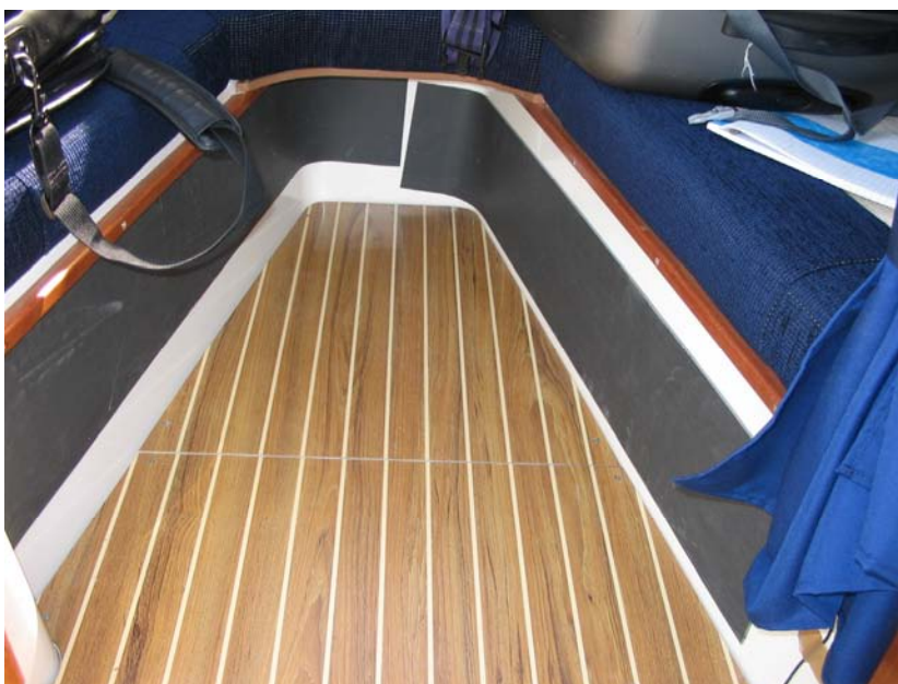
Kuva 43. K1-mod2, esimerkki paneelipintojen vaimennuksen lisäämisestä keulatilassa. Raskasmattoja on liimattu sisämoduulin lasikuitupaneeleihin.
