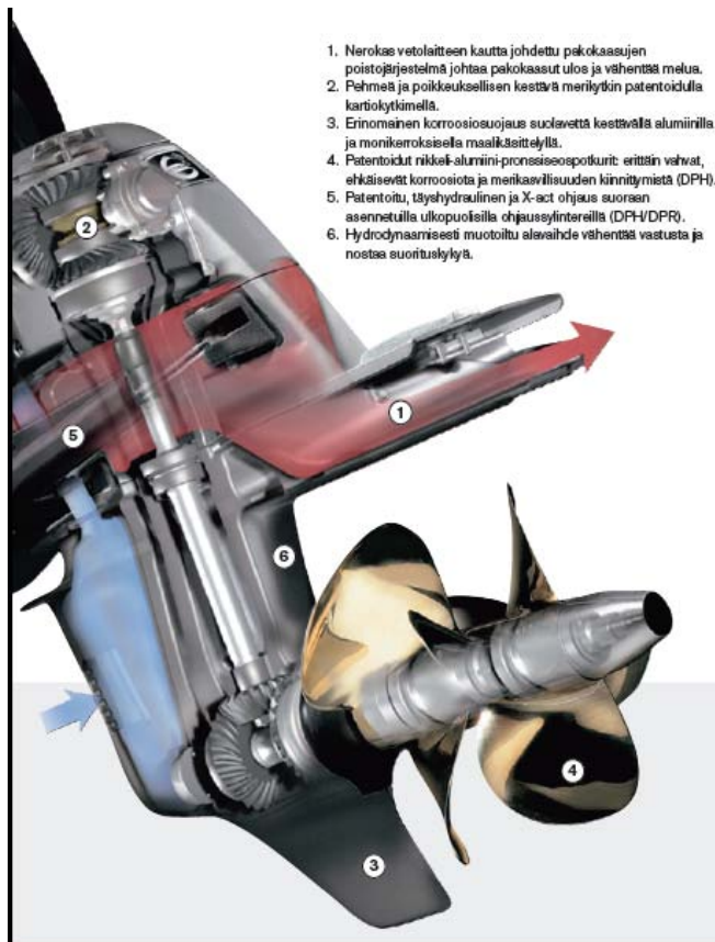
Kuva 5. Perävetolaitteen rakenne. 2
