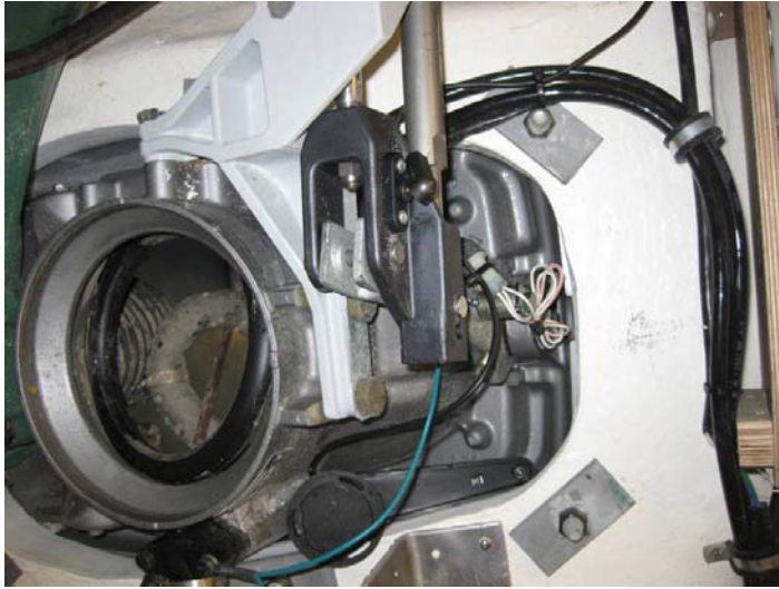
Kuva 2. Kumirengas ja kartio, joiden varassa moottorin takapäätä lepää.
