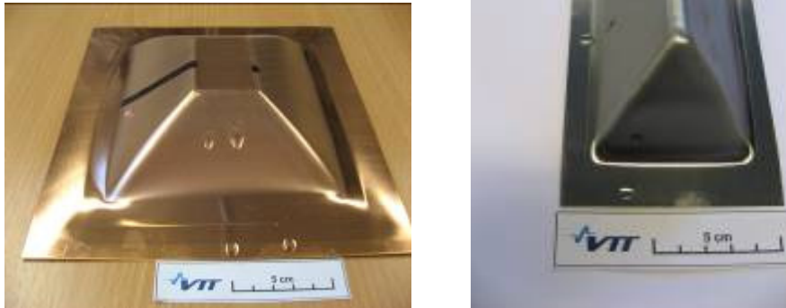
Kuva 19. Painomuovamalla ilman muottia valmistettuja koekappaleita: vasemmalla Cu-DHP+PSG21-näyte ja oikealla AISI304 DB+PSG21-näyte.
