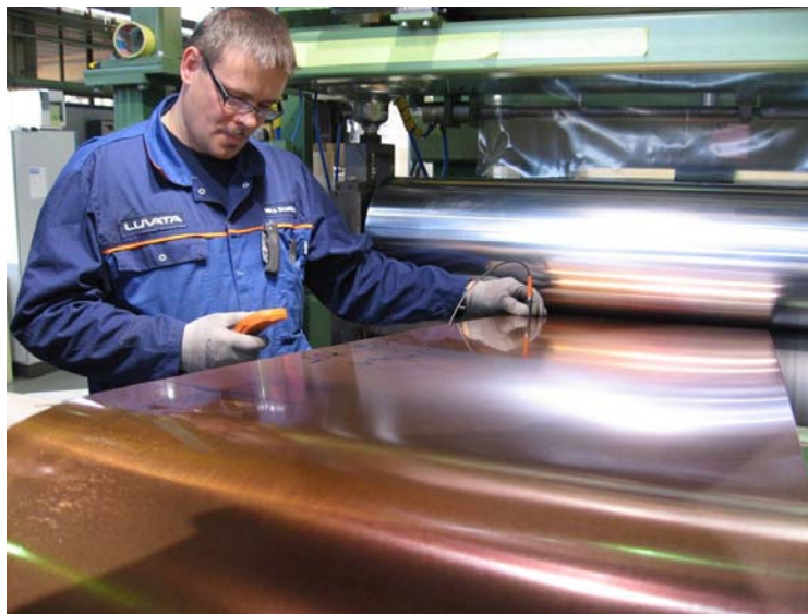
Kuva 17. Kokeissa demonstroitettiin, että sooli-geelipinnoitteen roll-to-roll-pinnoitus esi- ja jälkikäsittelyineen on mahdollista.
