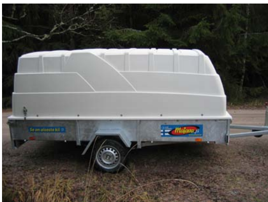
Kuva 16. Kuumasinkityt ja sooli-geelipinnoitetut peräkärä (vasemmalla) ja polkupyörä (oikealla). Pinnoitteen kovetus VTT:n patenttihakemuksessa esitetyn menetelmän mukaisesti (FI20085073//PCT/FI2009/050024).
