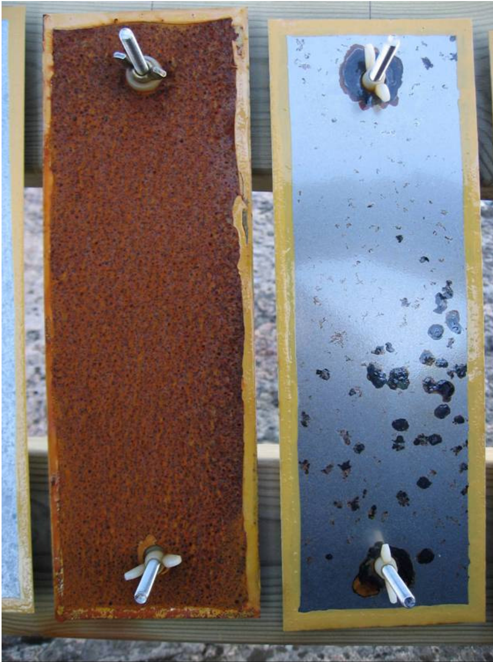
Kuva 27. Pinnoittamaton referenssilevy sekä MD1-pinnoitettu (hiiliteräs) Isosaaren 134 vuorokauden kenttäkokeen jälkeen.
