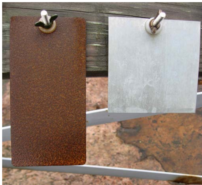
Kuva 25: Vasemmalla pinnoittamaton Fe 37 ja oikealla pinnoittamaton Zn99,95 -referenssinäyte Isosaaren kenttäkokeen jälkeen ja ennen peittäystä.
