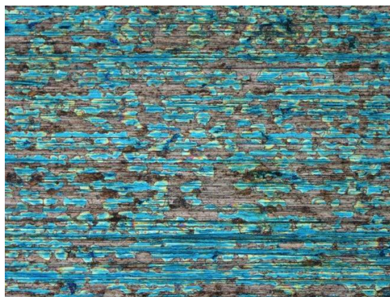
Kuva 43. Isosaaressa olleen ALD-TiO 2 -pinnoitetun EN 1.4301 ruostumattoman teräs -näytteen pinta altistuksen jälkeen.
