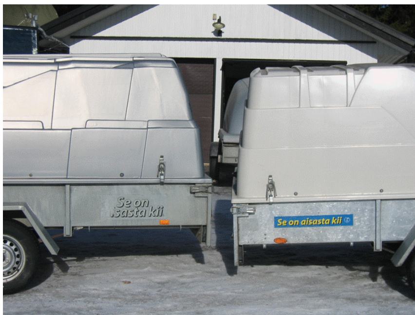
Kuva 31. Kuumasinkityn sooli-geelipinnoitetun (oikealla) ja pinnoittamattoman (vasemmalla) kärryn testauskäyttöolosuhteissa (kokeen kesto yli vuoden, ~ 20 000 kilometriä, myös talviolosuhteissa, kuva Suomen Kuumasinkitsijät ry).
