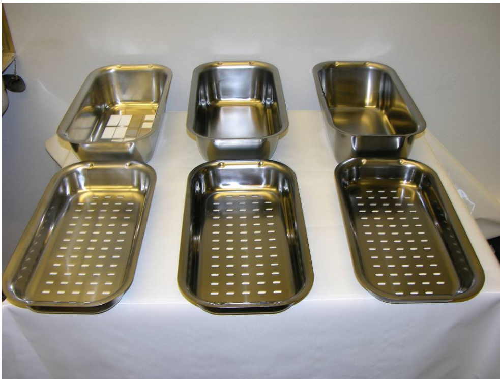
Kuva 35. Planar Systems Oy:n ALD-pinnoittamat Stala Oy:n tiskipöydän allas ja valutusastia. Pinnoittamaton allas ja valutusastia vasemmalla, pinnoitteella 181 pinnoitetut kappaleet keskellä ja pinnoitteella 881 pinnoitetut oikealla.
