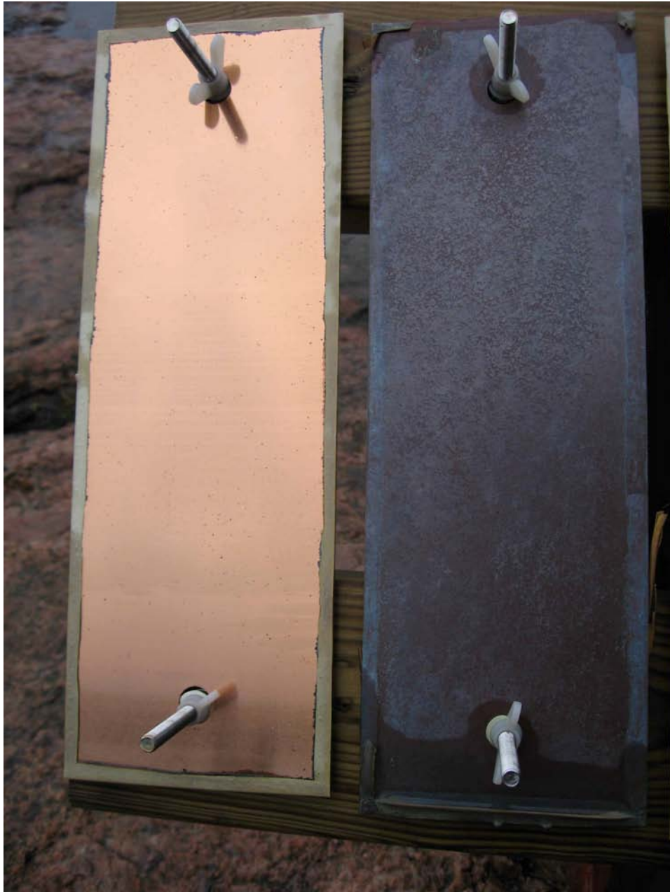
Kuva 26. MD1-pinnoitettu (paksu, n. 20 \mu\text{m} ) sekä MD2-pinnoitettu (ohut, 2 \mu\text{m} ) levy (puhdas kupari) Isosaaren 394 vuorokauden kenttäkokeen jälkeen.
