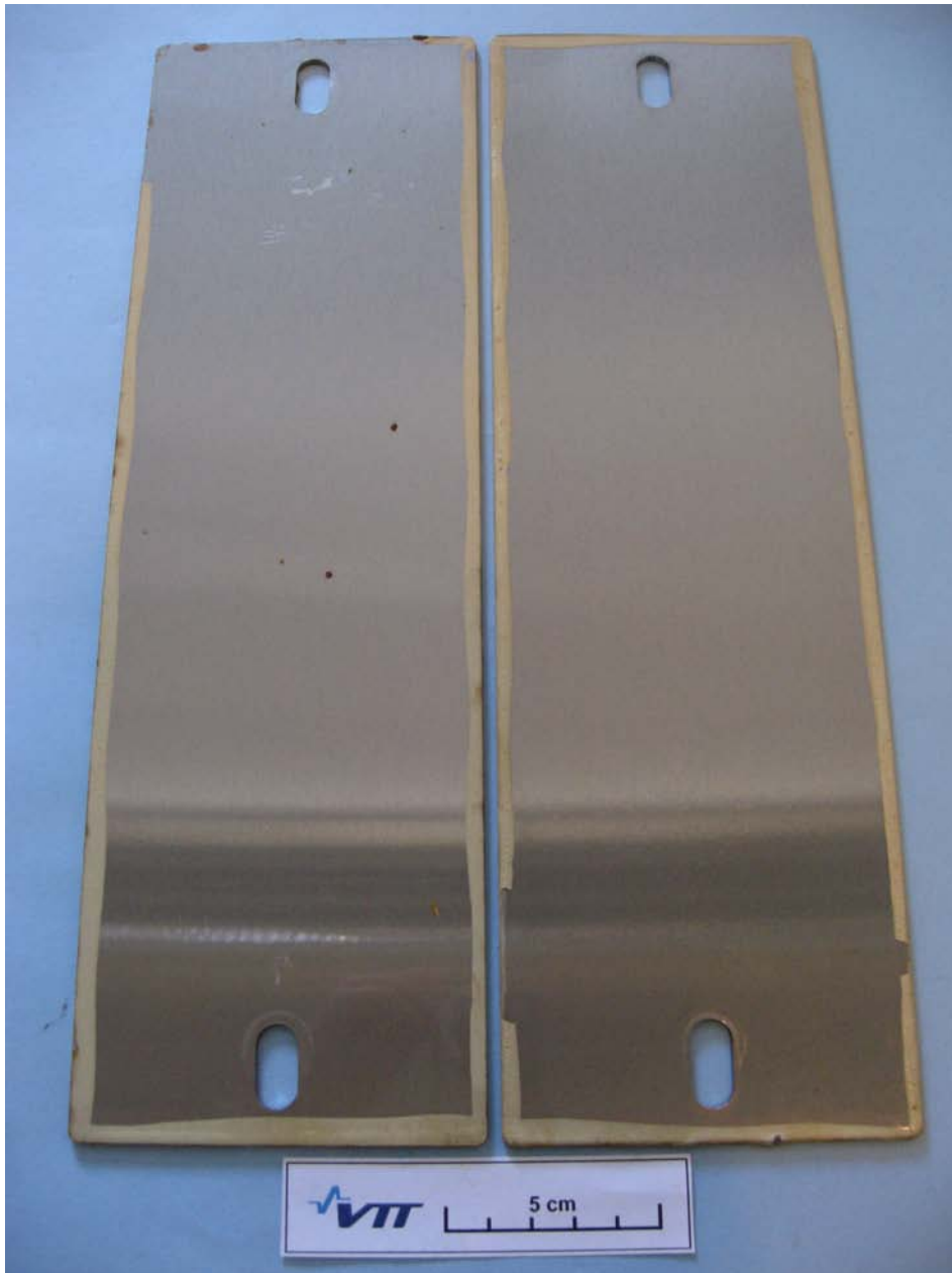
Kuva 28. Paksulla (50 \mu m) sooli-geelillä (oikealla) ja lakkapinnoitteella pinnoitettu (50 \mu m) AISi 304-teräslevy (vasemmalla) kestivät kokeen hyvin (552 vuorokautta) ilman merkittäviä vaurioita.
