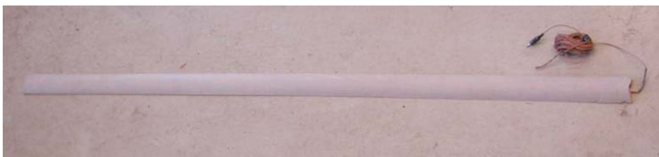
Kuva 3. Polyuretaanin valettu EMFi-liuska.
