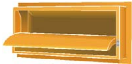
Kuva 28. Esimerkki seinään asennettavasta ulkoilmaventtiilistä, jonka säätölappä sulkeutuessaan suuntaa ilmavirran ylöspäin (Pellonpaja Oy).
