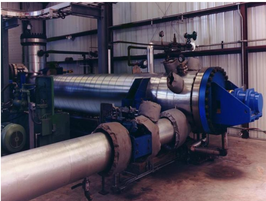
Kuva 4. Höyryräjäytin Abenerin selluloosaetanolin tuotannon pilot-mittakaavan koelaitoksessa [SunOpta, 2009].
