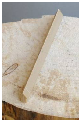
Kuva 111. Kehitetty passiivinen UHF-tunniste tukkien merkitsemiseen.
