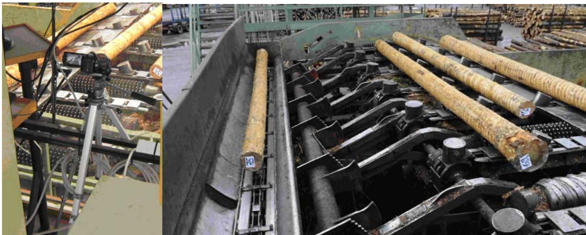
Kuva 115. Videokamera kuvaamassa ja järjestelmäkameralla otettu kuva ennen tukkimittaria.
