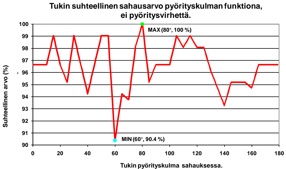
Kuva 79. Mäntytukki, jonka latvaläpimitta on 160 mm, suhteellinen sahausarvo tukin pyörityskulman funktiona. Sahausarvo on tukista saatavien sahatavaroiden, hakkeen ja purun arvojen summa. Tukin sahausasete pelkkasahauksessa on 19-100-19 ja jakosahauksessa 25-50-50-25.
