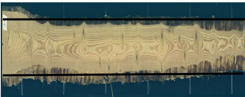
Kuva 88a. Läpisaheesta on särmämällä poistettu vajaasärmäisyyttä rimoitusta varten.
