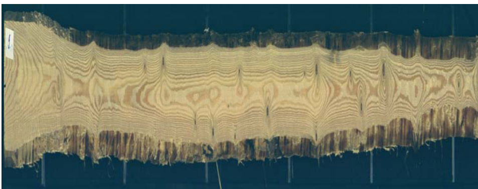
Kuva 87. Komponenttien valmistukseen konenäköjärjestelmällä lajiteltu läpisahe.
