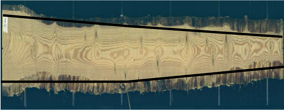
Kuva 88c. Läpisaheesta on poistettu vajaasärmäisyttä syrjien suuntaa mukailevilla särmäyksillä.
