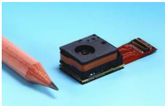
Kuva 8. Integroitu kameramoduuli, joka on valmistettu MID-teknikalla [Panasonic].
