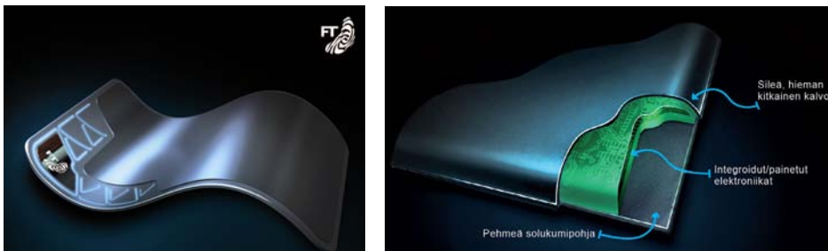
Kuva 63. Joustava rakenne mahdollistaa ohjainalustan taivuttamisen.
