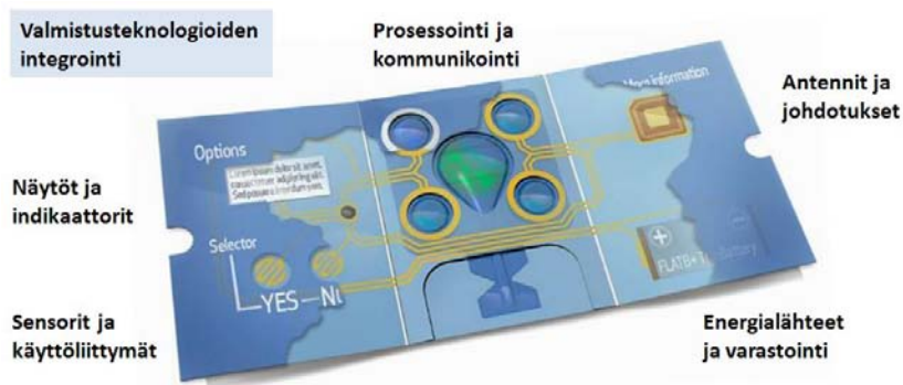
Kuva 3. Painetut hybridisysteemit yhdistävät erilaisia toiminnallisuksia ja valmistusteknologioita.
