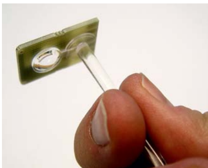
Kuva 22. Mikroskooppiläilaitteen linssi a) valun jälkeen ja b) LEDit päällä.
