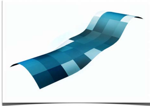
Kuva 51. Kalvo on muotoiltu siten, että kaareutumista on vain yhteen suuntaan kerrallaan.
