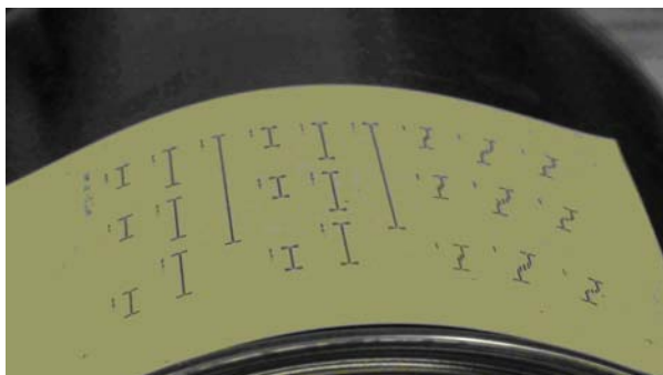
Kuva 10. Esimerkki johdinkuvioista joustavan LCP-kalvon pinnalla.
