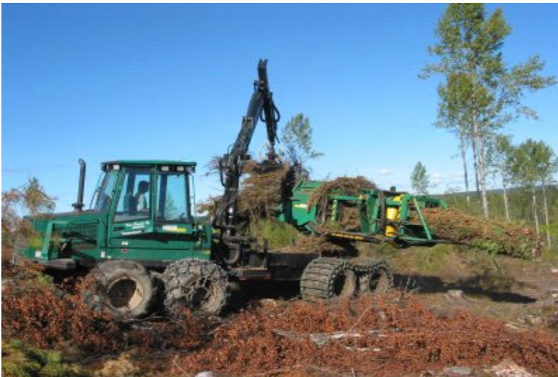
Kuva 23. Latvusmassan paalausta risutukeiksi hakkuutähdepaalaimella (J. Laitila, Metla).
