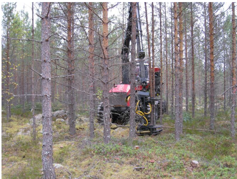
Kuva 55. Puiden keruulla hakkuulaitteeseen vähennetään kuormaimen liikkeitä ja tehostetaan hakkuutyön tuottavuutta yksinpuin käsittelyyn verrattuna (J. Laitila, Metla).
