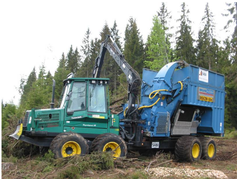
Kuva 17. Palstahakkuri hakettamassa latvusmassaa kuusikon pätehakkuualalla (J. Laitila, Metla).
