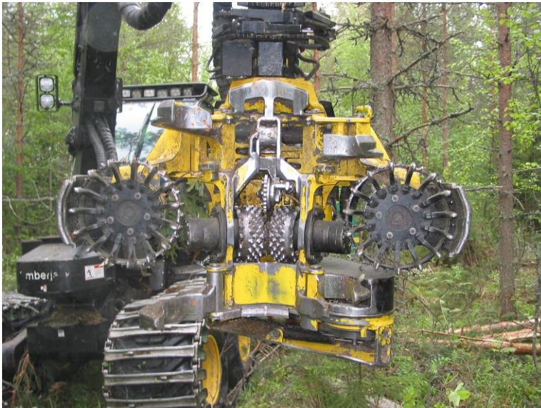
Kuva 30. Joukkokäsittelylaittein varustettu TJ 745 hakkuulaite, jolla voidaan korjata sekä aines- että energiapuuta, joko kokopuuna tai karsittuna, erilliskorjuuna tai integroituna korjuuna (J. Laitila, Metla).
