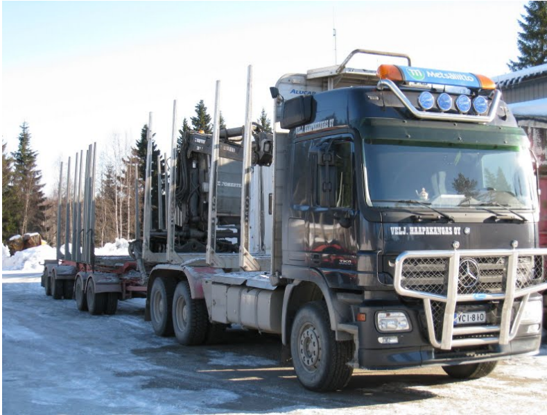
Kuva 19. Vakiorakenteinen puutavara-auto, jolla voidaan kuljettaa perinteisen ainespuun ohella latvusmassa- ja kokopuupaaleja sekä karsittua rankaa (J. Laitila, Metla).
