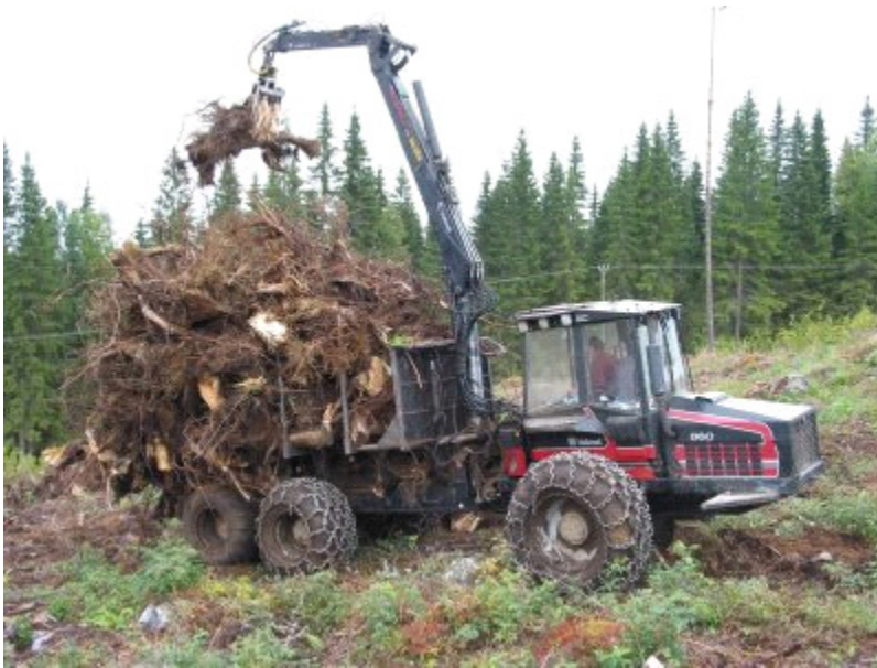
Kuva 26. Kantojen metsäkuljetusta metsätraktorilla (J. Laitila, Metla).
