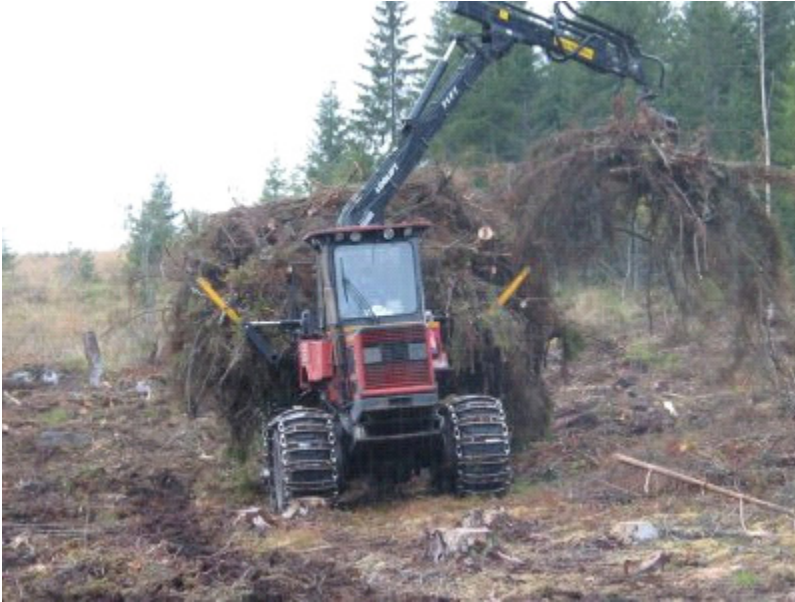
Kuva 22. Kuivahtaneen latvusmassan metsäkuljetusta yhdistelmäkoneella, jolla voidaan muokata uudistusala latvusmassan metsäkuljetuksen yhteydessä (K. Väätäinen, Metla).
