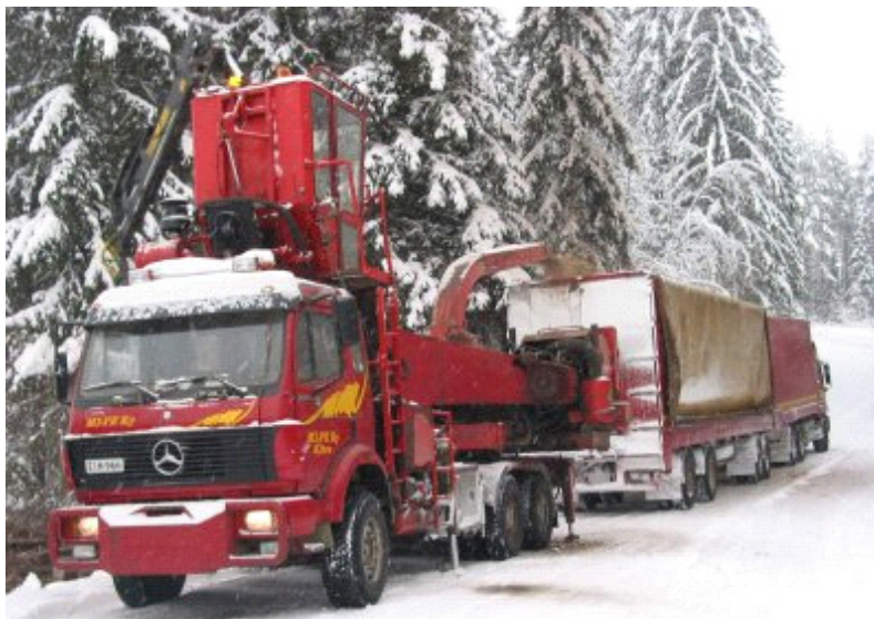
Kuva 16. Kuorma-auto alustainen hakkuri ja hakeauto (J. Laitila, Metla).
