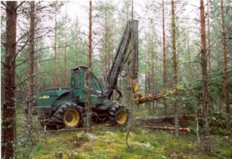
Kuva 27. Kokopuun kaato-kasausta keräävällä energiapuukouralla (J. Laitila, Metla).
