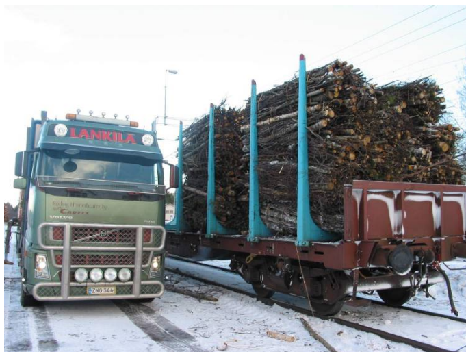
Kuva 35. Kokopuupaalien kuormausta puutavara-autosta puutavarajunan kyytiin (J. Laitila, Metla).
