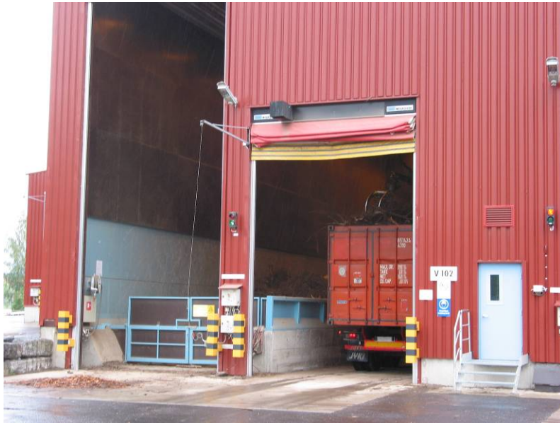
Kuva 14. Biomassarekka purkamassa kantokuormaa Jämsänkosken voimalaitoksen käyttöpaikkamurskaimen syöttökuljettimelle (J. Laitila, Metla).
