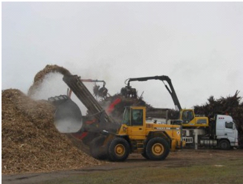
Kuva 15. Kantojen murskausta ja valmiin hakkeen kuormausta terminaalissa (J. Laitila, Metla).
