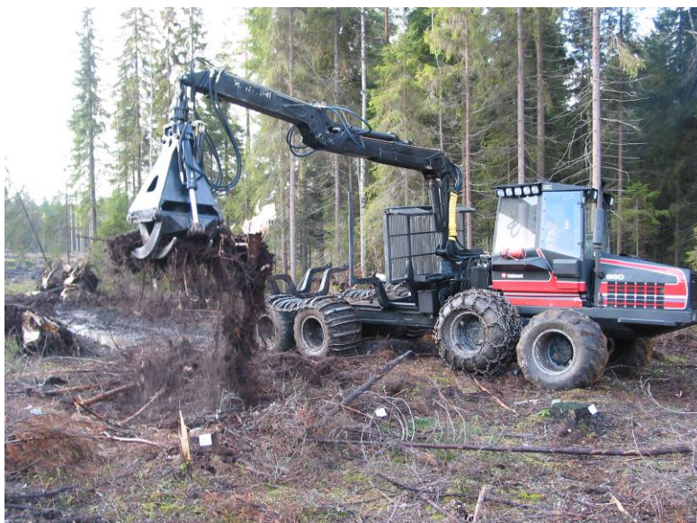
Kuva 53. Kantojen nosto- ja paloitteluaika kuormatraktorialustaisella kantokorjurilla (J. Laitila, Metla).
