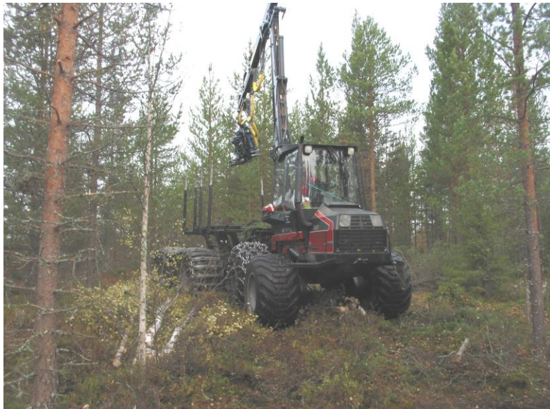
Kuva 28. Energiapuukorjuri avaamassa ajouraa energiapusavotalla (J. Laitila, Metla).
