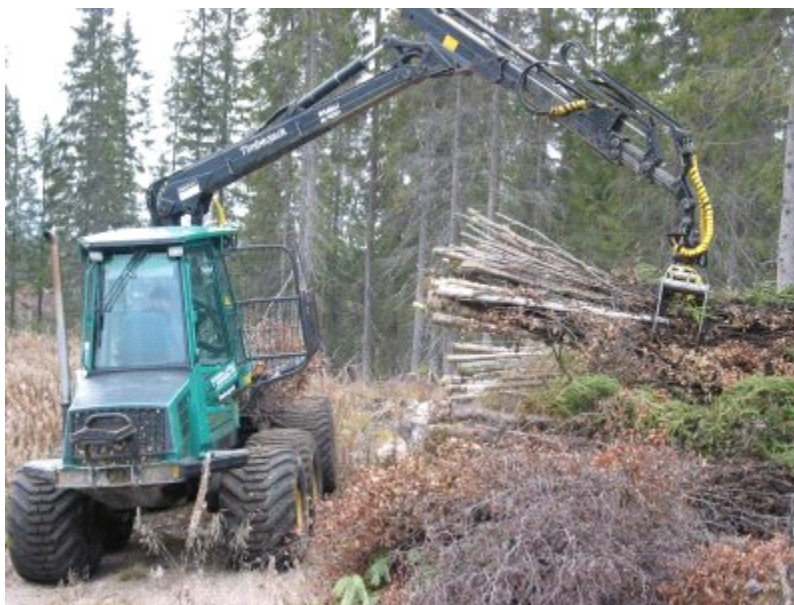
Kuva 29. Kokopuukuorman purkua tienvarsivarastolla (J. Laitila, Metla).
