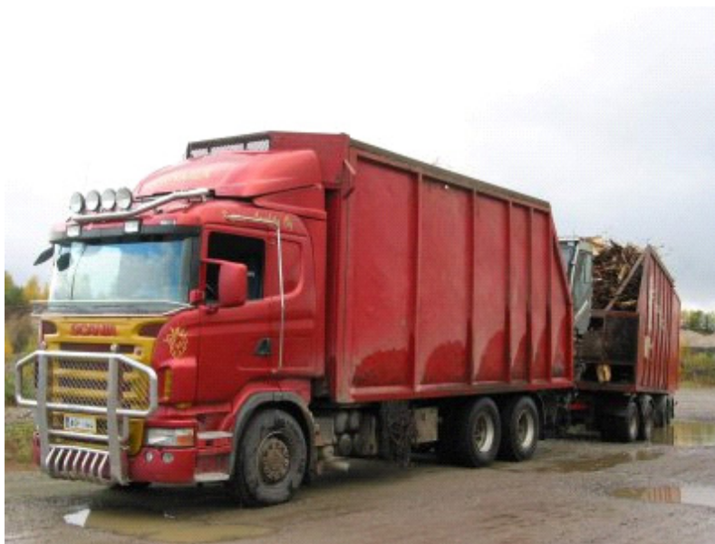
Kuva 18. Hakettamattoman metsäbiomassan kaukokuljetuksessa käytettävä ajoneuvoyhdistelmä (J. Laitila, Metla).
