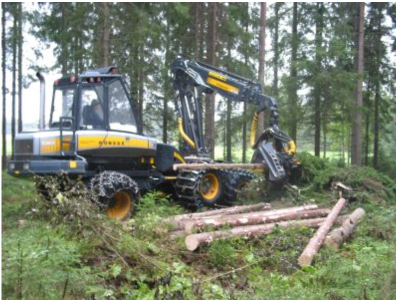
Kuva 21. Latvusmassan esikasaus yhdistettynä ainespuun hakkuuseen (J. Laitila, Metla).
