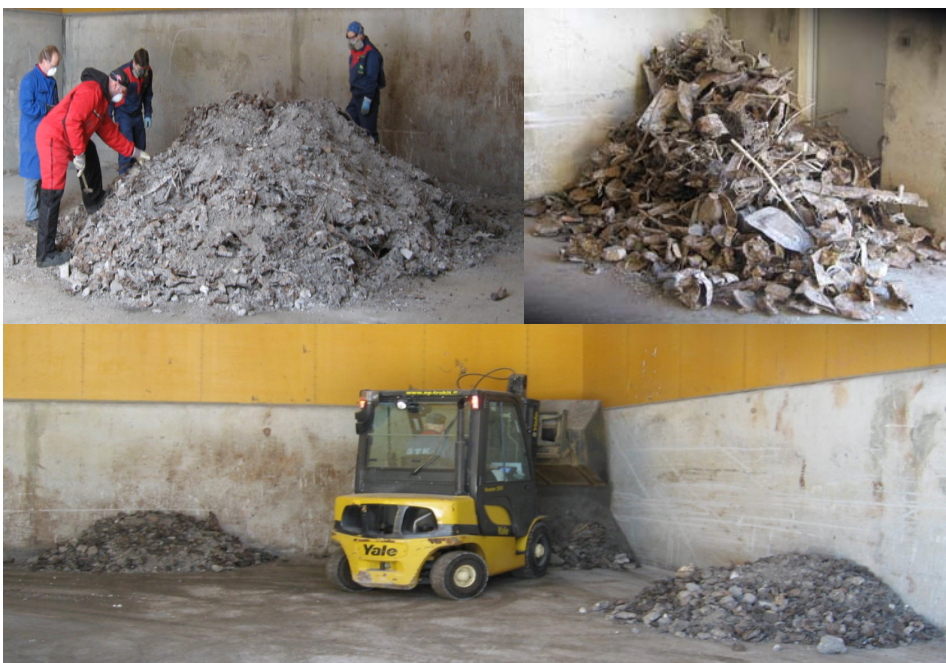
Kuva 8. Ylhäällä suurten metalli- yms. kappaleiden poisto manuaalisesti, alhaalla jäljelle jääneen tutkittavan kuonamateriaalin jako neljään osaan.
