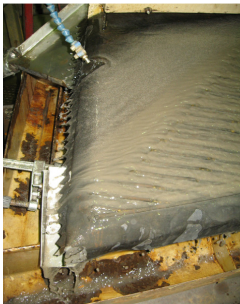
Kuva 12. Painovoimaerotus tärypöydällä ei-magneettiselle < 4 mm:n fraktiolle.
