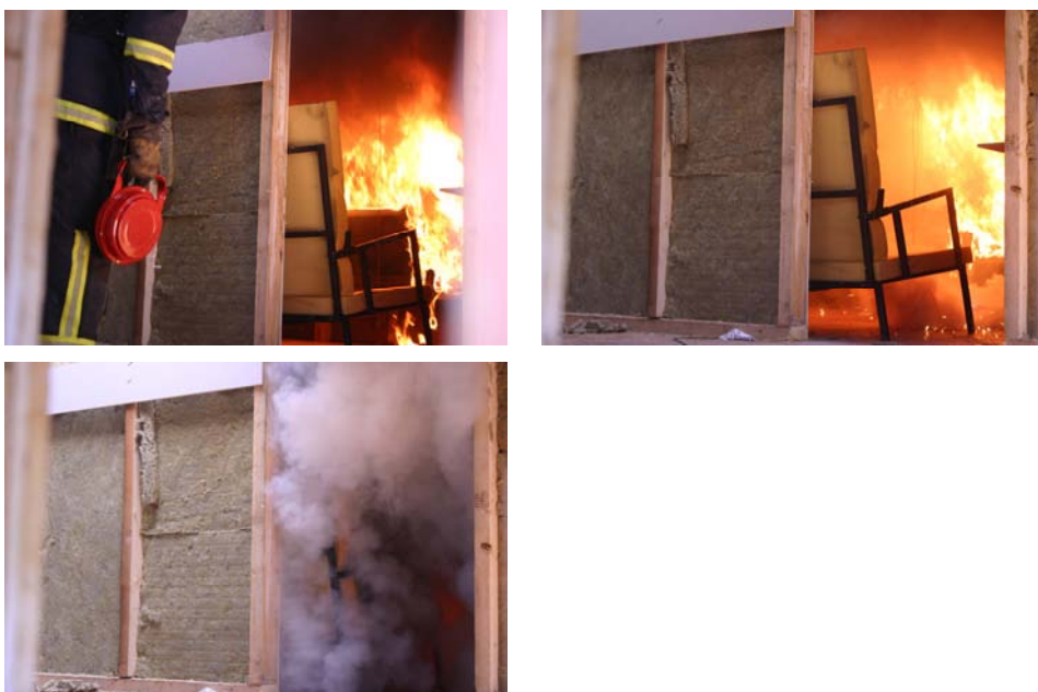
Kuva 35. Kuvasarja heittosammuttimen asentamisesta palavaan huonetilaan (tapahtumien ajallinen kesto yhteensä n. 1 min).
