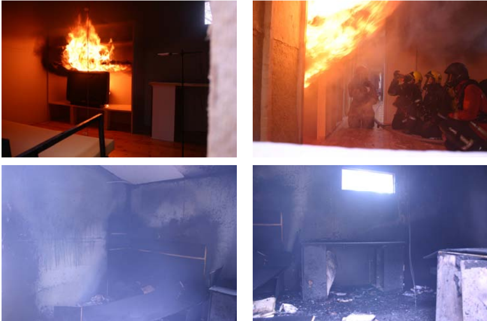
Kuva 10. Valokuvia sytytyshetkestä huonetilan lieskahdukseen (yllä) ja kuvia huoneen sisältä palon sammuttamisen jälkeen (alla).
