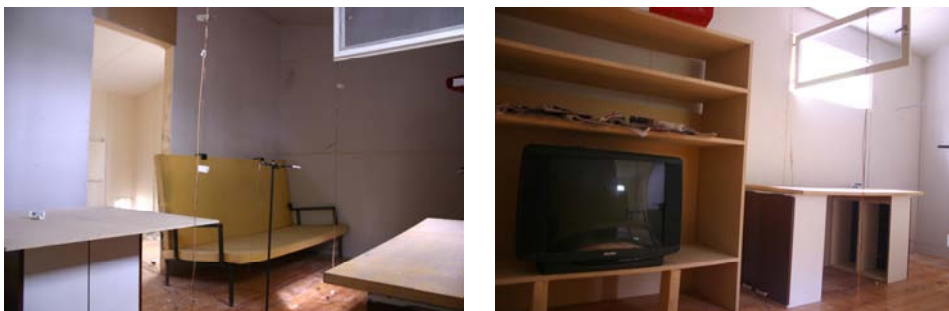
Kuva 5. Huonetila, jossa pääosin lastulevystä koostunut palokuorma.
