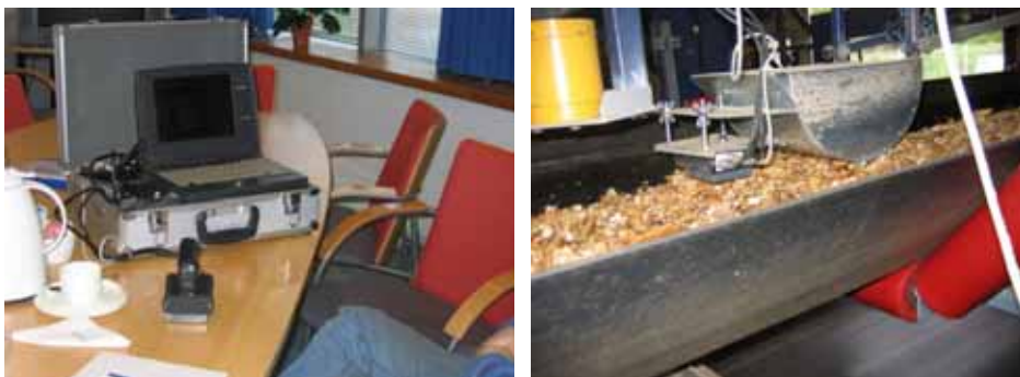
Kuva 67. Impedanssispektroskopiaan perustuva ”käsimitari” ja mittarin anturi online-sovelluksessa.
