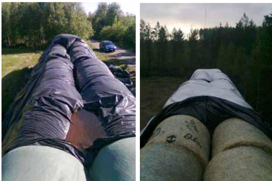
Kuva 33. Molempien koeaumojen päälle muodostui "vesipusseja", joista peitteen rikkoutuessa vesi valuu varastoon ja kastelee auman keskellä olevia helpipaaleja. Vasen kuva on otettu Sirkkasuon aumasta varastoa purettaessa kesäkuun alussa 2010.
