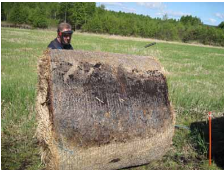
Kuva 30. Pohjakerroksen paalien maata vasten olevat osat olivat tummuneet sekä kosteudesta että maa-aineksesta. Kuvan paalin maata vasten oleva osa oli 20 cm:iin saakka kosteudeltaan yli 70 %, mutta sisemmät kerrokset olivat kuivia.
