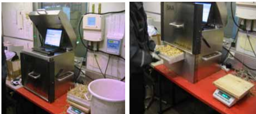
Kuva 58. Senfitin BMA-mittari: oikealla laite valmiudessa ja vasemmalla näyteastia työnnetään mittauskammioon.
