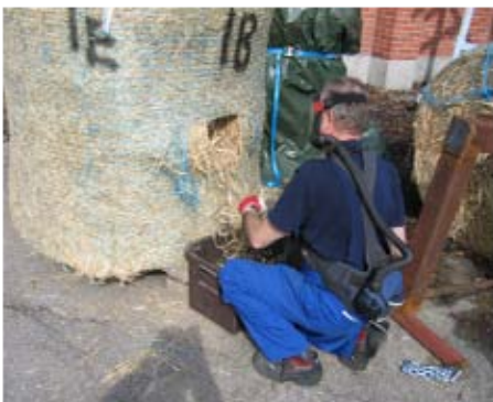
Kuva 50. Leikkausnäytteenottoa ja kaavio näytteenoton suunnista toisesta (kuivasta) koepaalista. Kuiva paali merkitty 1:sellä.
