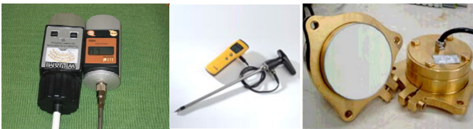
Kuva 55. Kapasitiivisiä mittareita vasemmalta oikealle: Wile-25 (uusi digitaalinen malli: Wile Bio Moisture/Farmcomp Agroelectronics), Protimer Balemaster GE Infrastructure Sensing ja Hantor MMS online -kosteusanturi.
