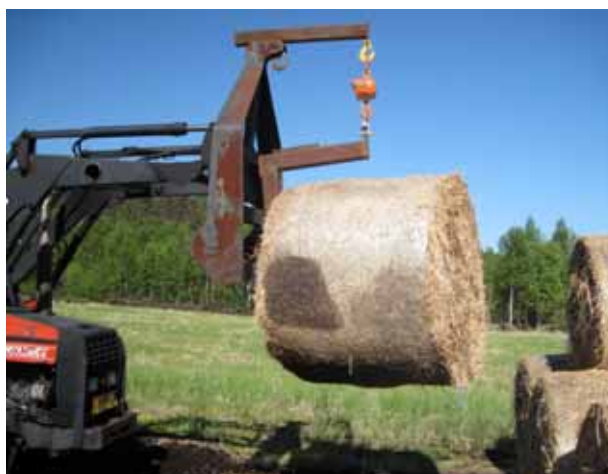
Kuva 21. Varastoja purettaessa koepaalit punnittiin traktorin etukuormaajaan rakennetulla riippuvaakajärjestelmällä.
