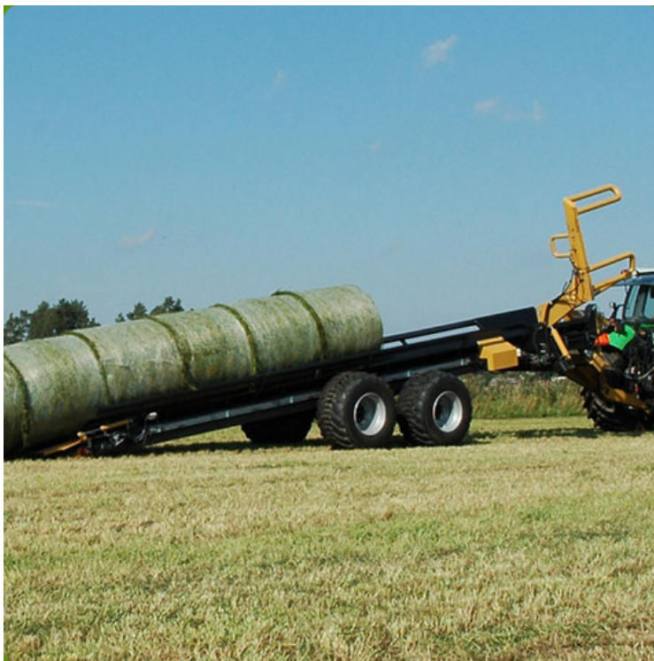
Kuva 11. NHK-pyöröpaalivaunu tyhjennysvaiheessa. (Kuva: NHK-Keskus Oy).
