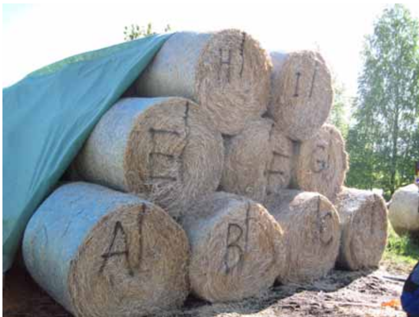
Kuva 29. Sirkkasuon auman tutkimusleikkaus vihreällä kestopelliteellä peitetystä osasta. Mustalla muovipeitteellä peitetystä leikkauksessa käytettiin samoja merkintöjä vastaavissa koepaaleissa.
