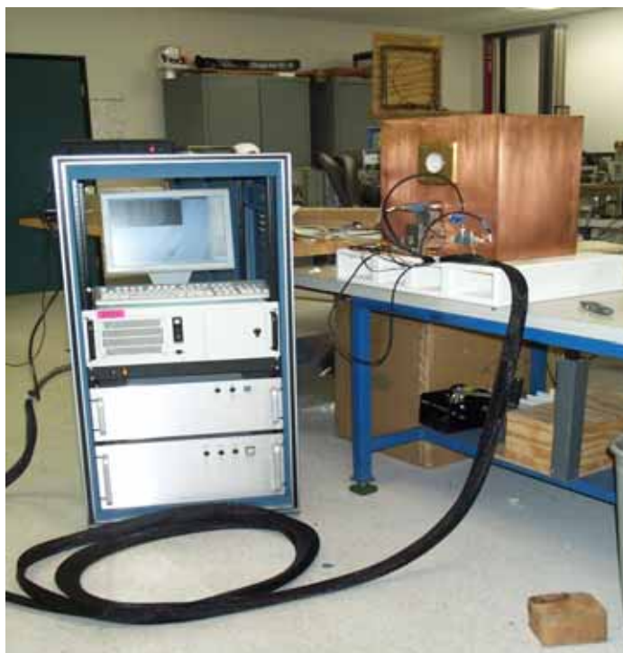
Kuva 61. Kevyt NMR-laitteisto. Pöydällä magneetti, RF-kela ja vahvistin sekä laitetelineessä PC ja virransyöttökaapelit. Kaapeli mittausyksikköön on 6 m (Magnusson, 2005).
