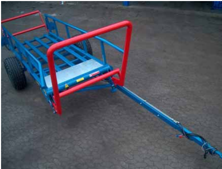
Kuva 10. Tanskalainen Fasterholt-paalivaunu, joka voidaan kytkeä pyöröpaalaimen perään. (Kuva: Fasterholt Maskinfabrik A/S).
