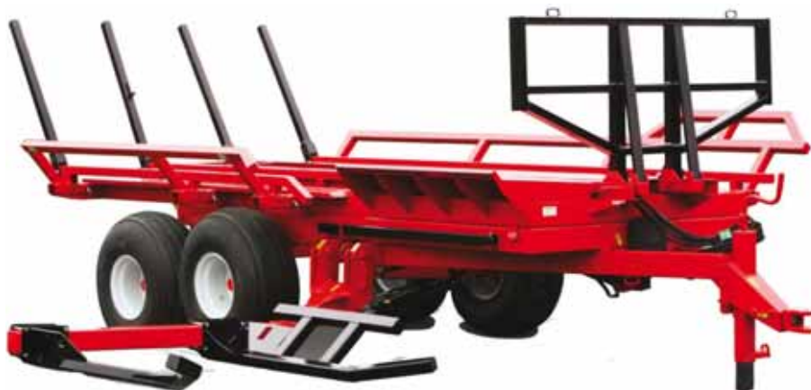
Kuva 12. Kanadalainen Anderson TRB-pyöröpaalivaunu. (Kuva: Anderson Group co.).
