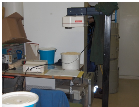
Kuva 68. Infrapunasäteen kulku MM710 -mittapäässä (NDC Infrared Engineering manuaali 2004) ja purun kosteuden atline-mittausta VTT:ssä.
