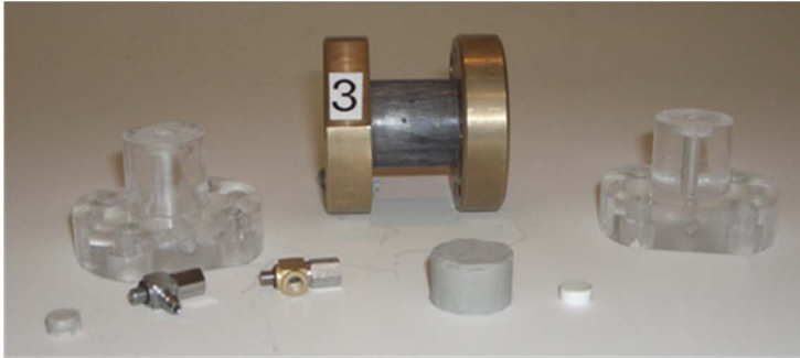
Kuva 27. Bentoniittinäyte ja kostutuskammio osiin purettuna. Bentoniittinäyte on puristettu hiilikuituputkeen, ja sitä voidaan kostuttaa pohjassa olevan sinterilevyn kautta. Kammio on jäykkä eikä muuta muotoaan merkittävästi bentoniitin kostuessa ja pyrkiessä turpoamaan.
