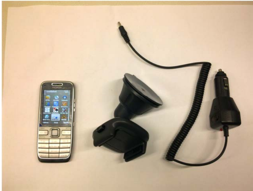
Kuva 16. Junavaroitusjärjestelmän kokeilussa hyödynnetty ajoneuvolaitteisto.
