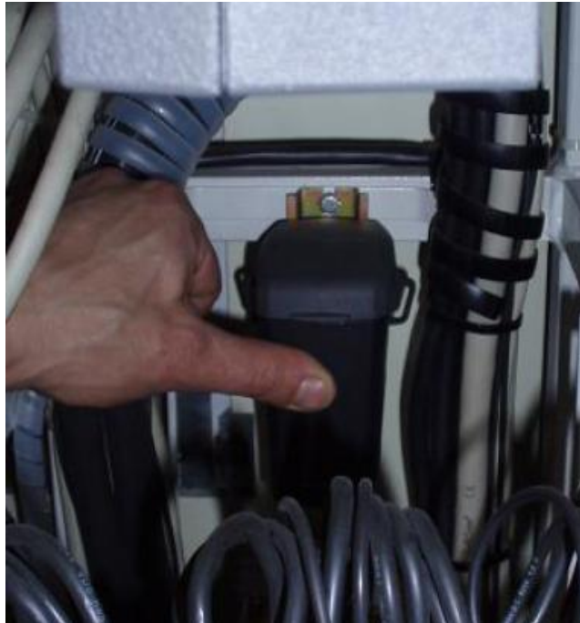
Kuva 17. Apicom A1 Trax paikallaan Dm12-kiskobussissa.
