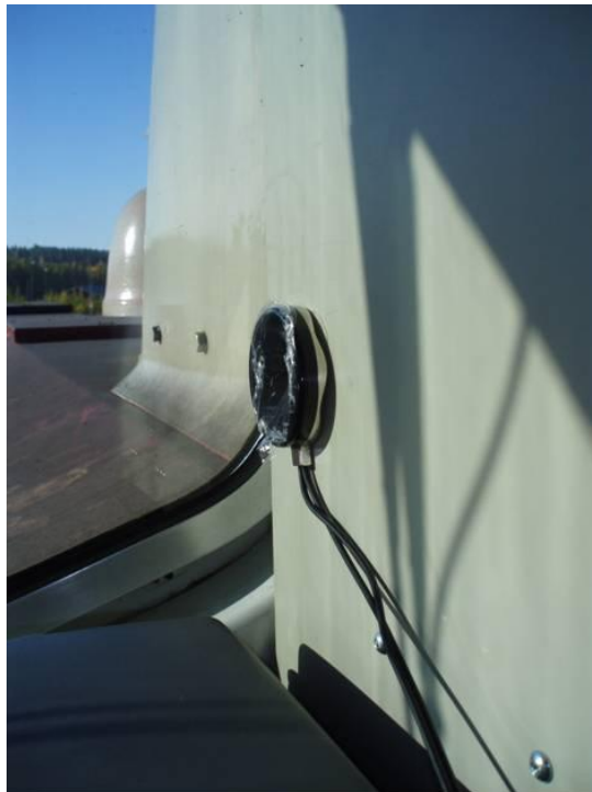
Kuva 23. CL341-laitteen antennien asennuspaikka Dv12-dieselveturin ohjaamossa.
