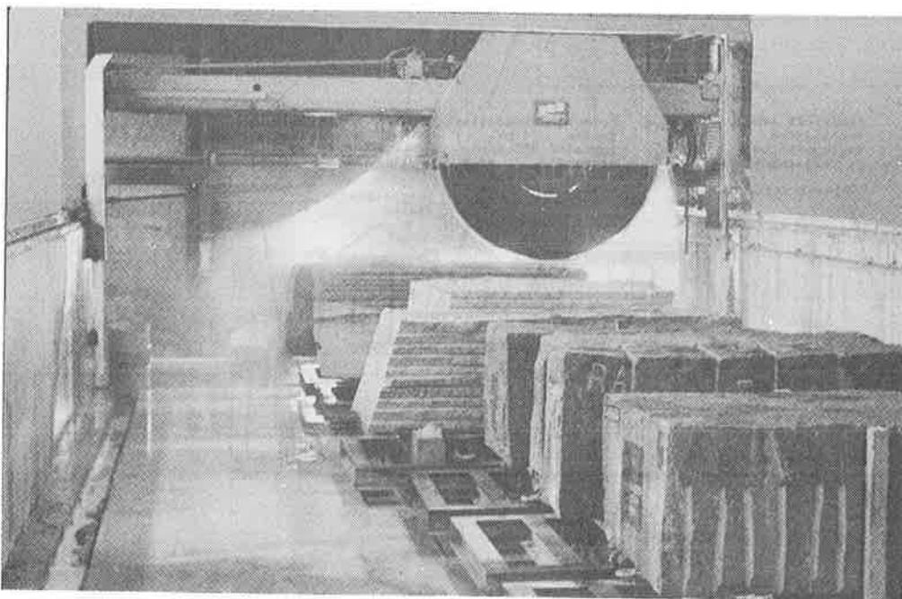
Kuva 61. Automaattiohjattava timanttipyörösaha (Lähde: Eisenwerk Hensel Bayreuth. Esite).
