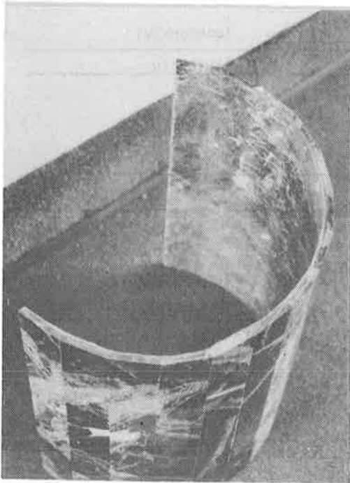
Kuva 53. Lasikuidulla lujitetusta, ohuesta marmorilevystä valmistettuja kuorielementtejä.
